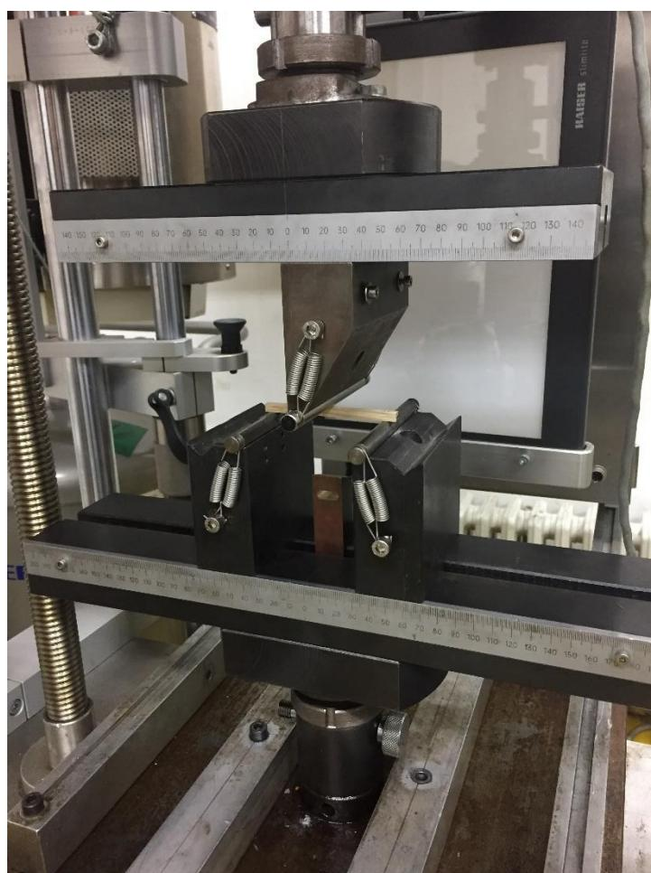
Slika 45. Metoda savijanja u tri točke na kidalici
