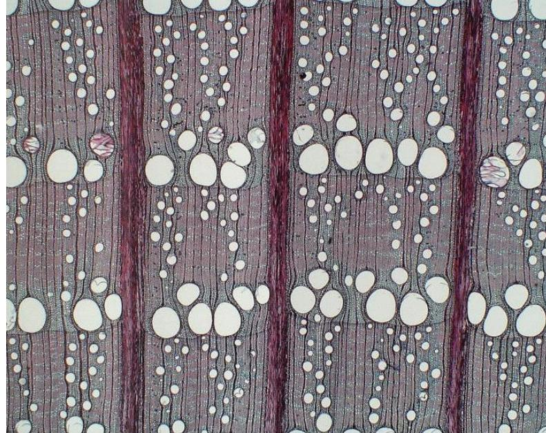
**Slika 39. Mikrostruktura poprečnog presjeka hrasta lužnjaka, [22]**
