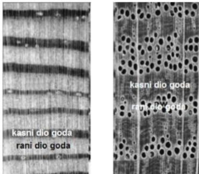
**Slika 6. Poprečni presjek četinjače (lijevo) i listače (desno), [2]**
