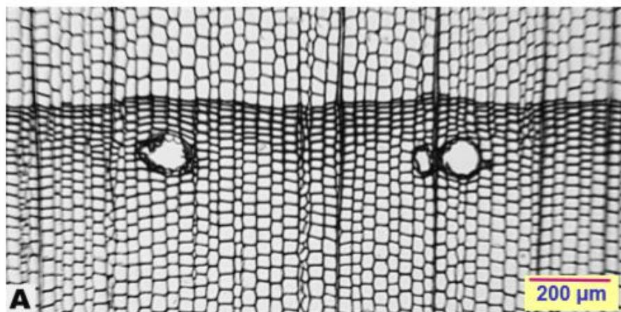
**Slika 13. Poprečni presjek kroz drvo četinjače, [2]– oblik traheida**
