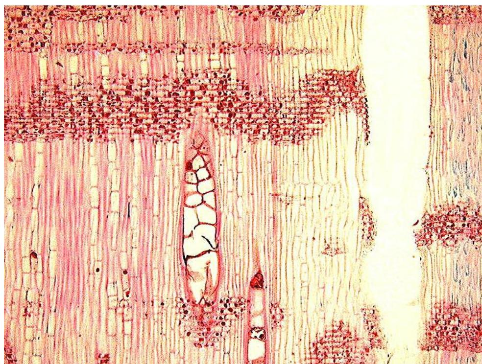
Slika 41. Mikrostruktura radijalnog presjeka hrasta lužnjaka, [22]
