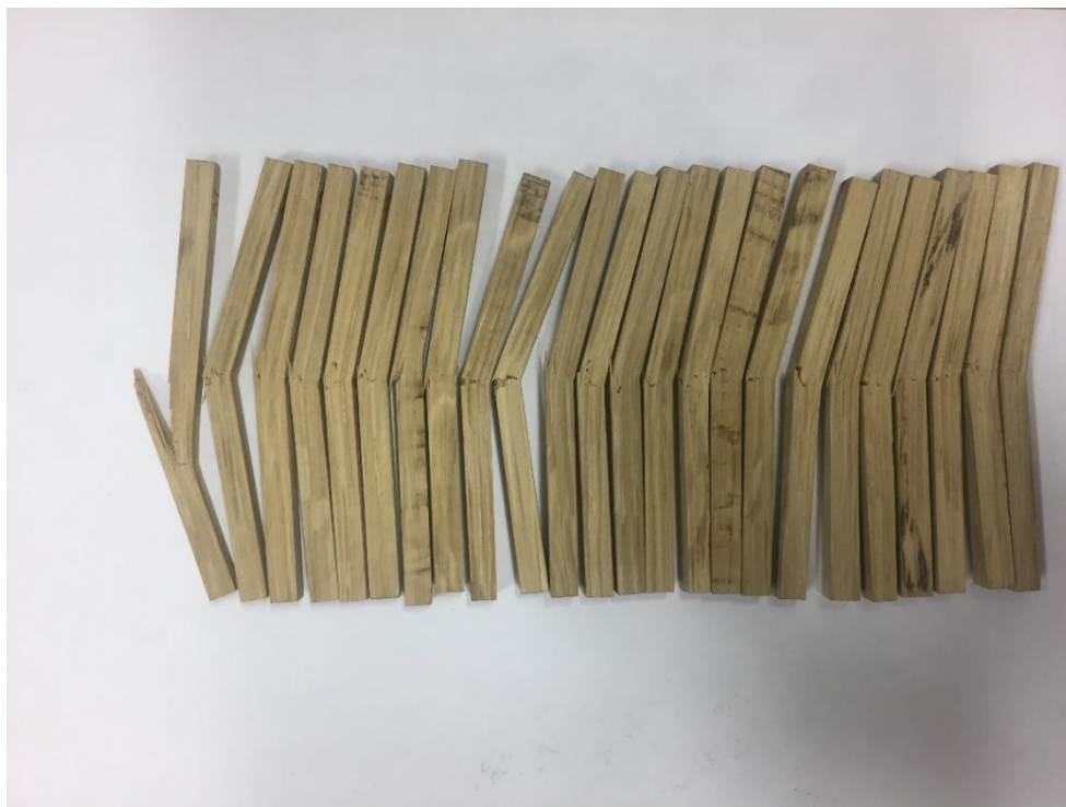
Slika 46. Prva skupina (skupina A) uzoraka nakon ispitivanja
