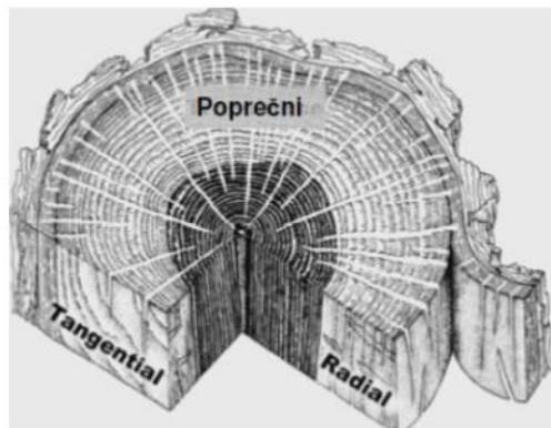
Slika 3. Tri karakteristična presjeka u drva, [2]
