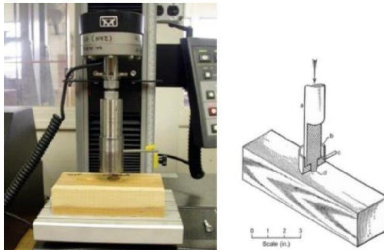
**Slika 32. Uredaj za ispitivanje tvrdoće drva metodom po Janki, [17]**
