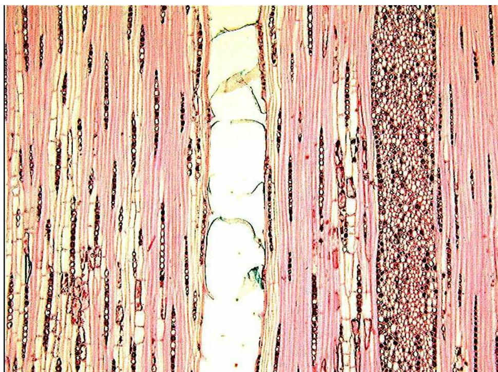
Slika 40. Mikrostruktura tangencijalnog presjeka hrasta lužnjaka, [22]
