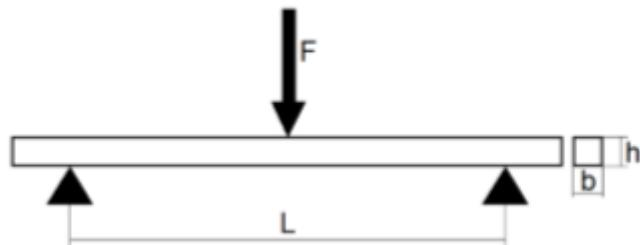
Slika 44. Metoda savijanja u tri točke, [12]
