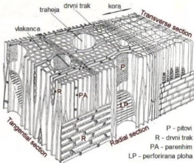
**Slika 15. Mikrostruktura drva listača, [6]**
