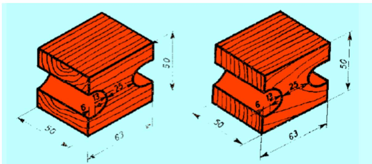
**Slika 26. Uzorci za ispitivanje vlačne čvrstoće, [14]**
