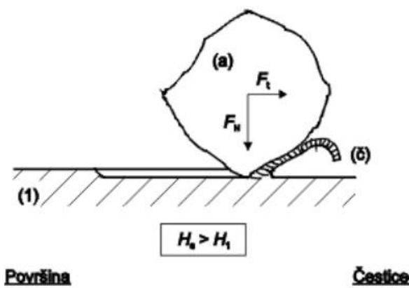
**Slika 33. Abrazijsko trošenje, [18]**
