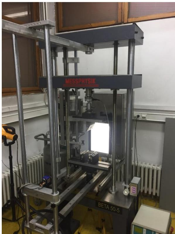
**Slika 43. Kidalica MESSPHYSIK BETA 50-5 u labaratoriju za eksperimentalnu mehaniku**
