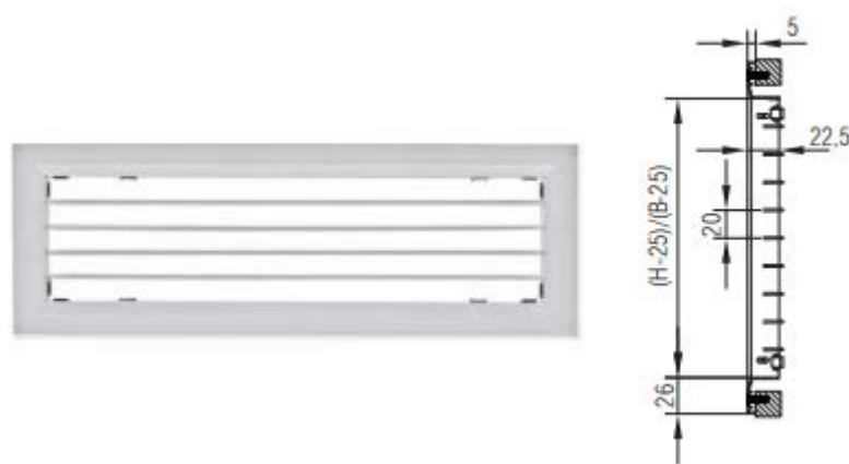
Slika 45 Ventilacijska rešetka OAH - 1
