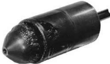
**Slika 29. Karakterističan izgled nakon uništenja flashingom [2]**
