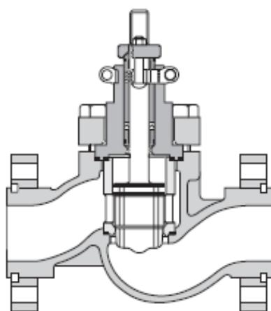
Slika 2. Regulacijski ventil s rasterećenim pladnjem [1]
