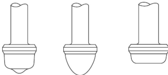
**Slika 10. Karakteristični pladnjevi; istopostotni, linearni, brzootvarajući [2]**
