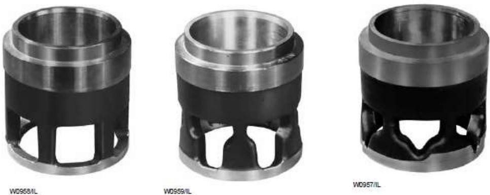
**Slika 11. Karakteristični kavezi regulacijskog ventila; brzootvarajući, linearni, istopostotni [2]**
