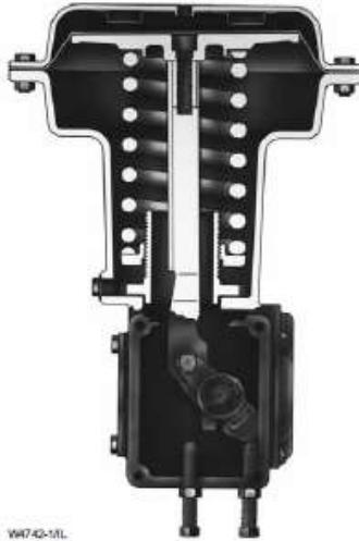
**Slika 26. Membranski pneumatski motor [2]**
