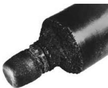
**Slika 28. Karakterističan izgled nakon uništenja flashingom[2]**
