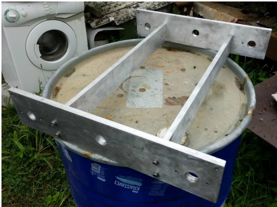
Slika 49. Praktični postav (postolje i X osi)
