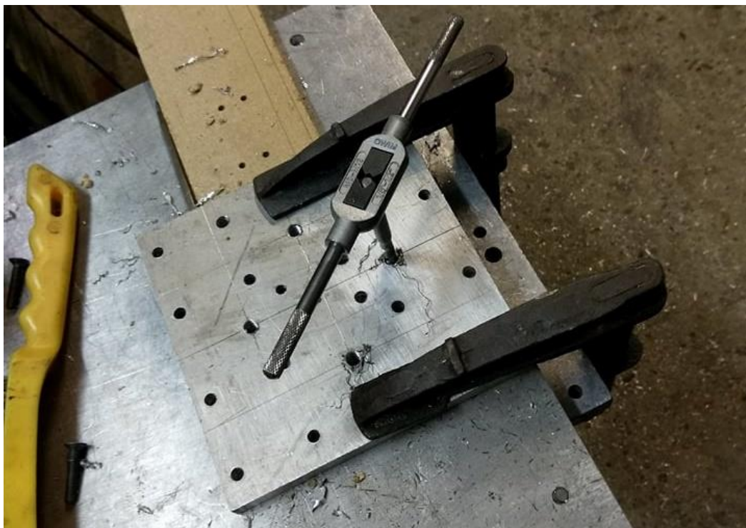
Slika 54. Praktični postav (urezivanje navoja)
