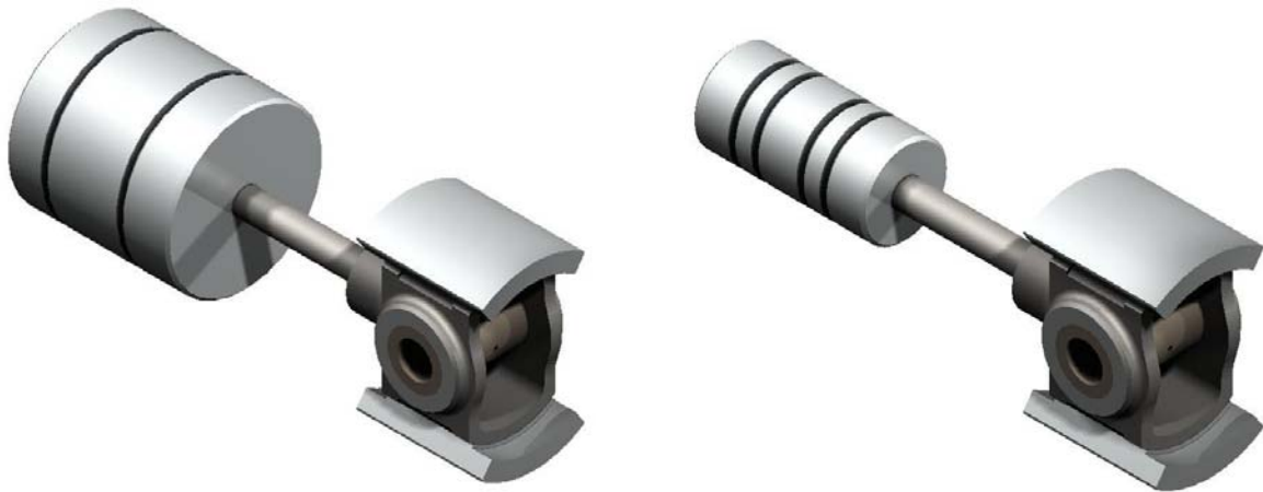
Slika 11. Križna glava i stap prvog stupnja (lijevo) i drugog stupnja (desno)
