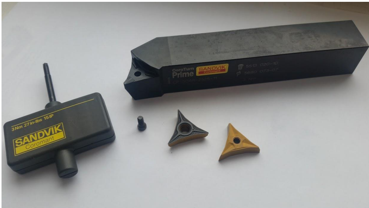
Slika 24. Držač alata, dvije pločice A- tipa, vijak i moment ključ
