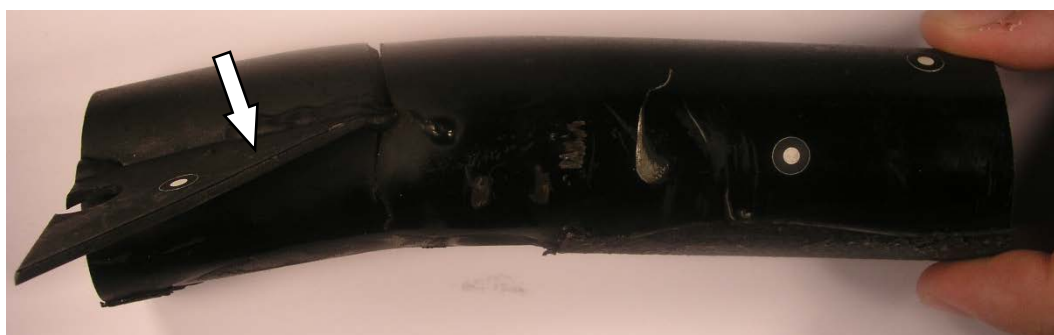
Slika 8. Plastična deformacija uzorka
