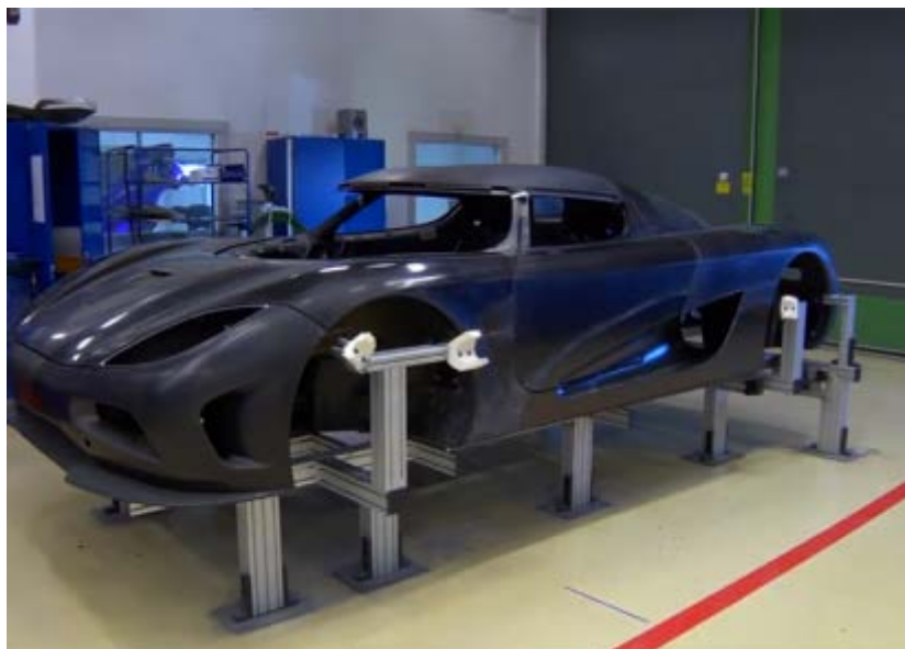
Slika 6. Oplata automobila izrađena od kompozita ojačanog ugljičnim vlaknima [10]
