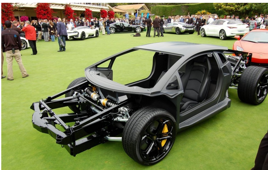
Slika 5. Podsklop okvir kod sportskog automobila Lamborghini Aventador [7]
