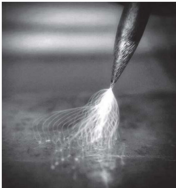
Slika 13. Uspostava električnog luka visokofrekventnim generatorom [14]
