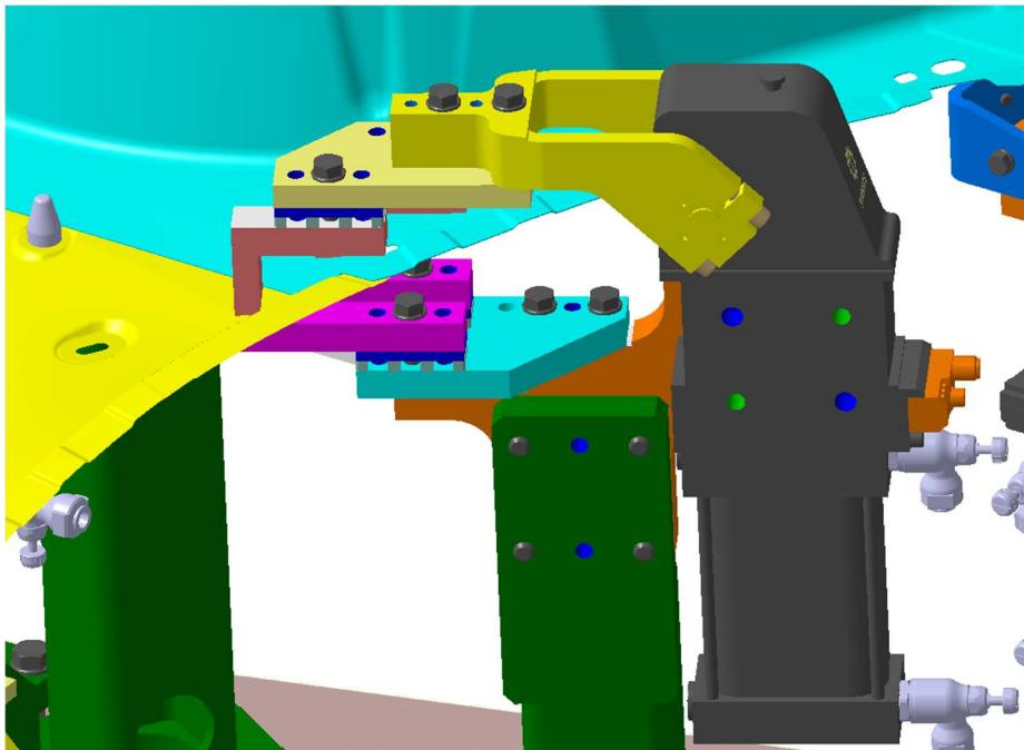
**Slika 17. Prikaz automatske stege u fazi konstruiranja stroja**
