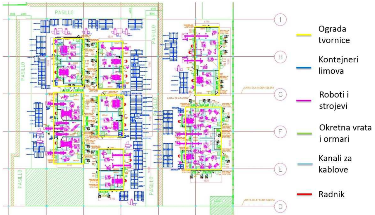
Slika 1. Shema dijela tvornice
