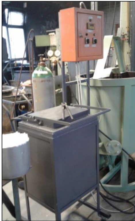
Slika 4.7 Peć za toplinsku obradu u zaštitnoj atmosferi argona
