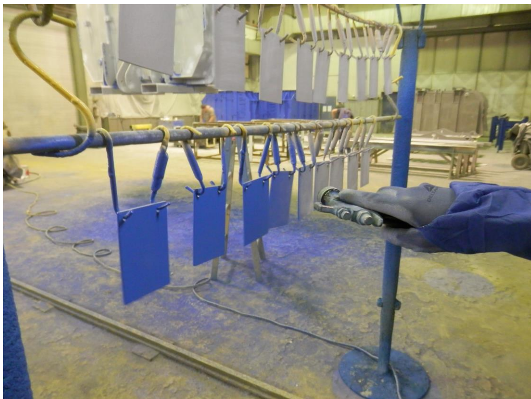
Slika 15. Nanošenje završnog premaza na uzorke, Midi d.o.o.
