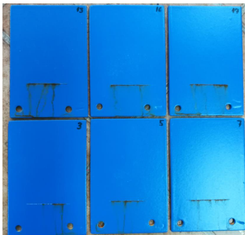
Slika 27. Uzorci nakon 720 h u slanoj komori
