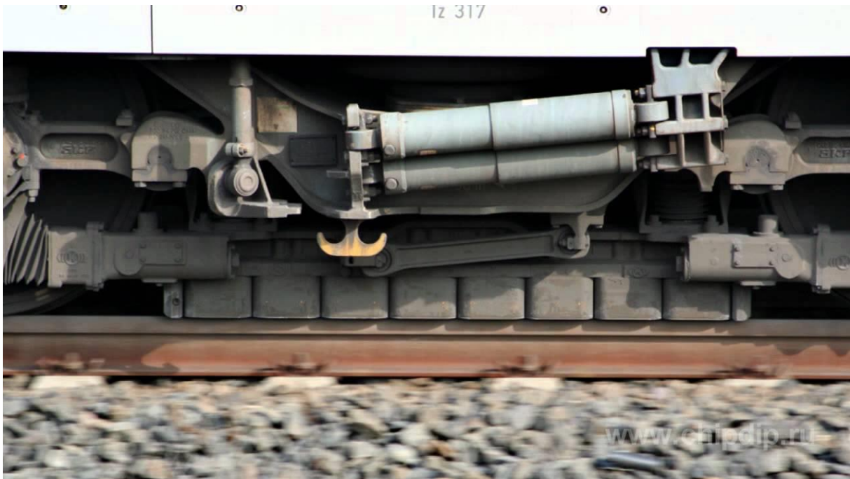
Slika 5. Elektromagnetna tračnička kočnica s niskim ovjesom
