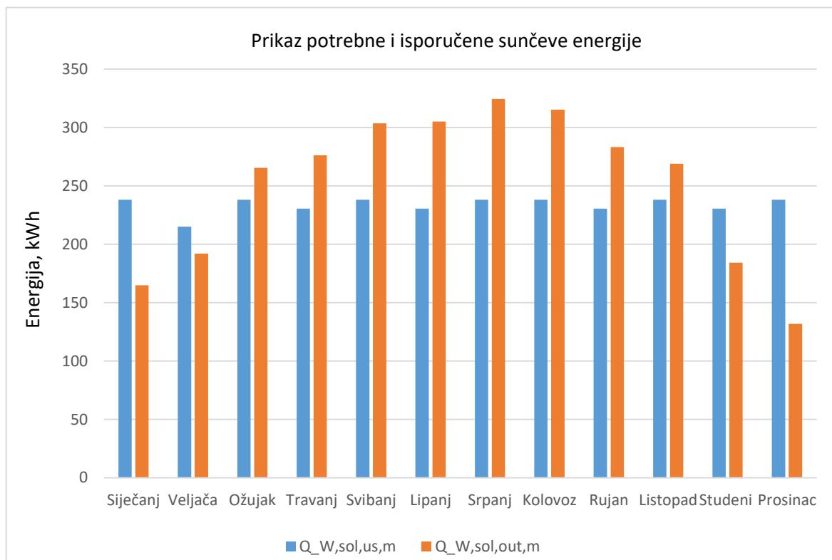
**Slika 6.5 Prikaz za površinu kolektora  $9.28 \text{ m}^2$**
