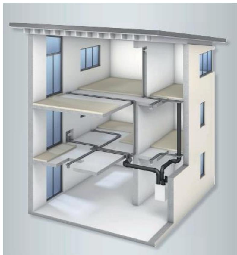
Slika 1.7 Centralni ventilacijski sustav
