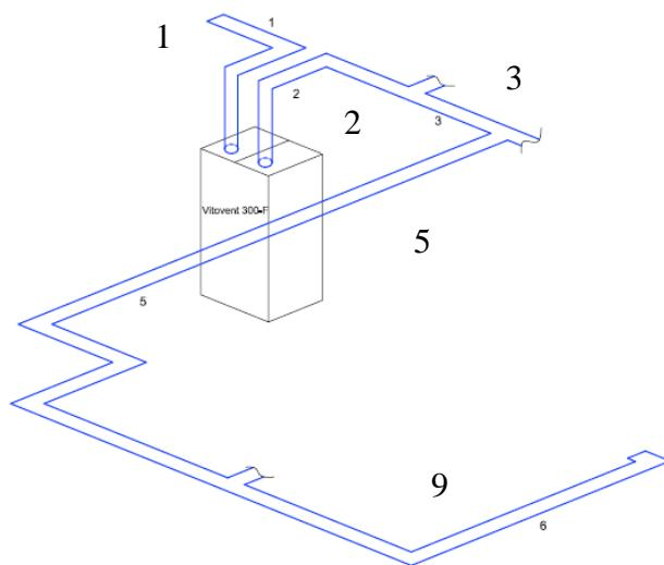
**Slika 7.4 Pojednostavljeni izometrijski prikaz kritične dionice ventilacije**
