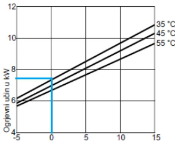
Slika 4.2 Ovisnost ogrjevnog učina o temperaturama primarnog i sekundarnog kruga
