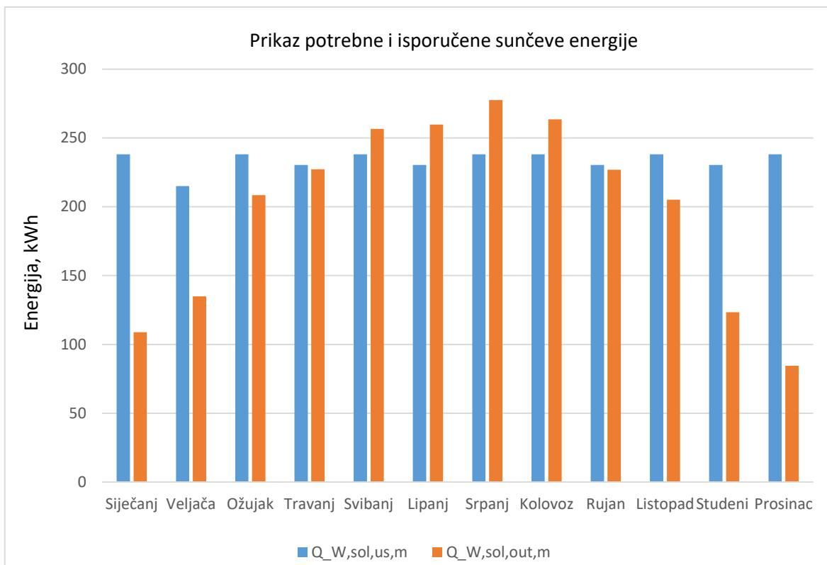
**Slika 6.4 Isporučena (narančasto) i potrebna (plavo) energija za zagrijavanje PTV-a za površinu kolektora  $4.64 \text{ m}^2$**
