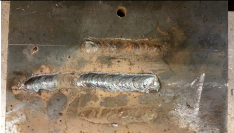
Slika 39. Zavar ispitnog uzorka 1 i ispitne ploče
