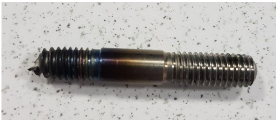
Slika 42. Ispitni uzorak broj 2 nakon loma
