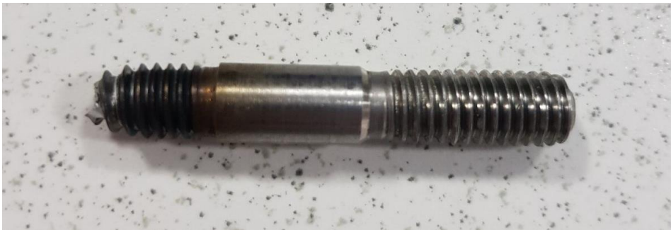
Slika 40. Ispitni uzorak 1 nakon loma
