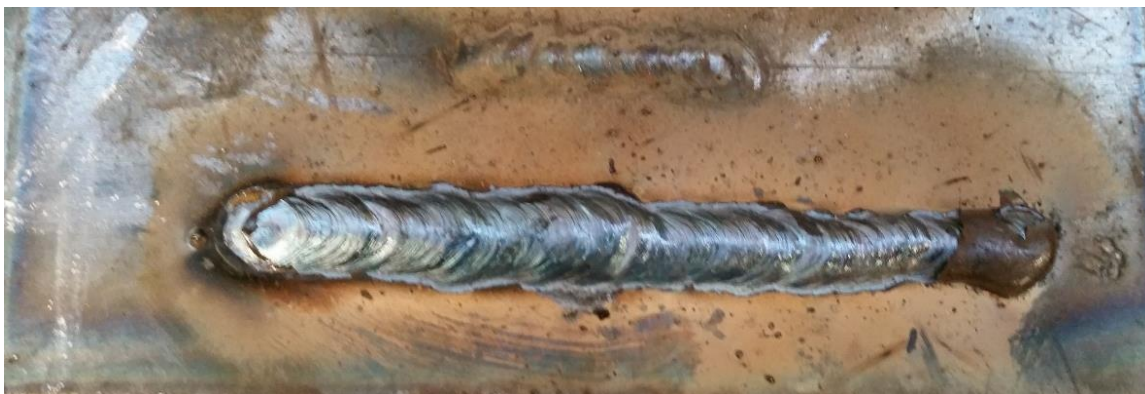
Slika 45. Zavar ispitnog uzorka broj 4 i ispitne ploče
