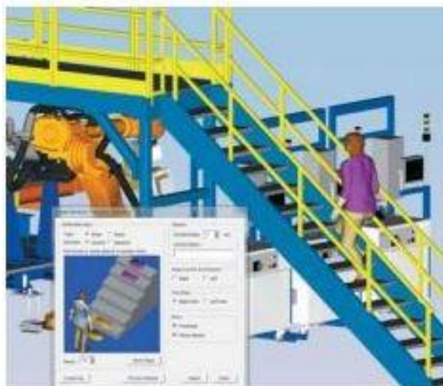
Slika 19. Prikaz radnika i analize radnje (penjanje po stepenicama) [12]
