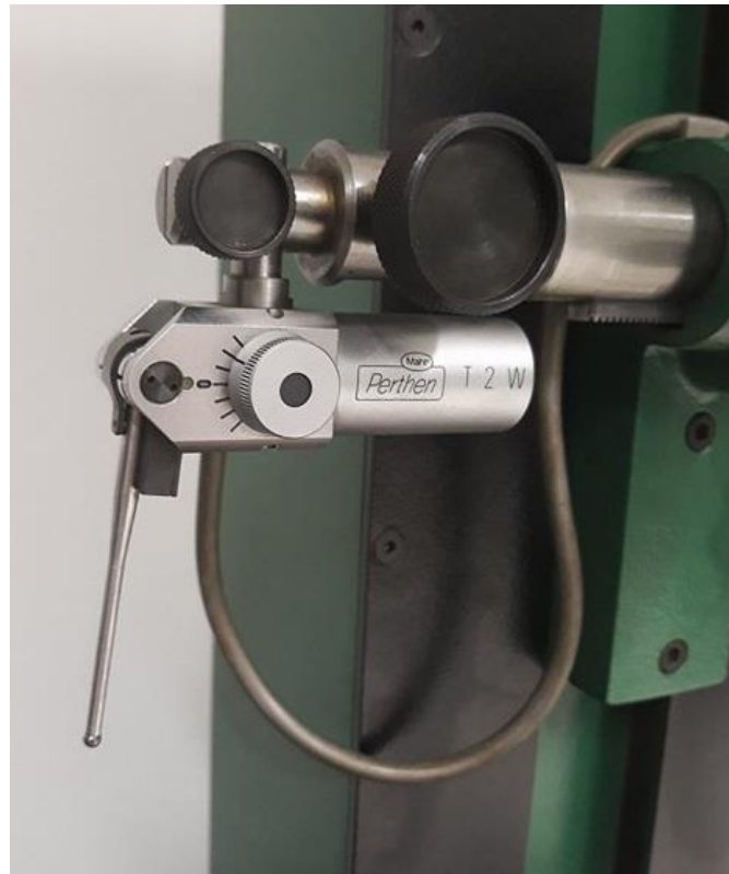
Slika 7 Induktivno ticalo uređaja za mjerenje kružnosti
