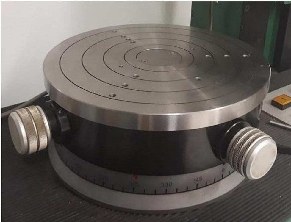
Slika 6 Okretni stol uređaja za mjerenje kružnosti
