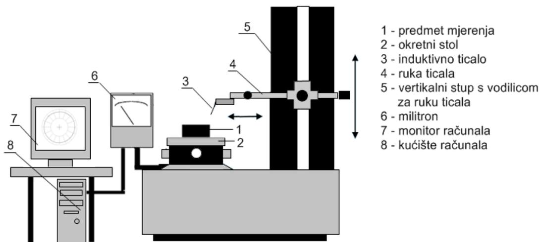
Slika 5 Osnovni dijelovi uređaja „MMQ-3“ za ispitivanje kružnosti
