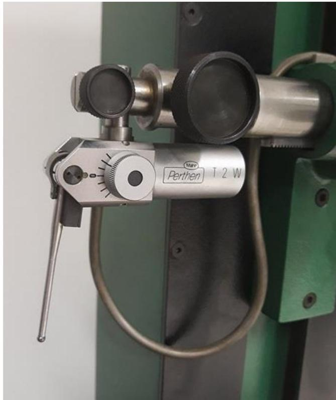
Slika 7 Induktivno ticalo uređaja za mjerenje kružnosti
