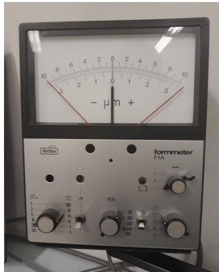
Slika 8 Elektronski uređaj za mjerenje i upravljanje (millitron)
