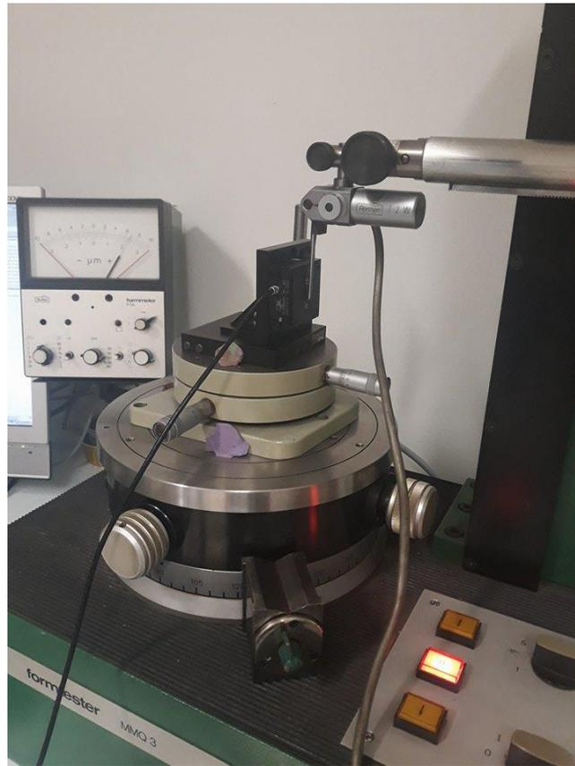
Slika 19 Postavljanje piezo aktuatora na MMQ-3 uređaj
