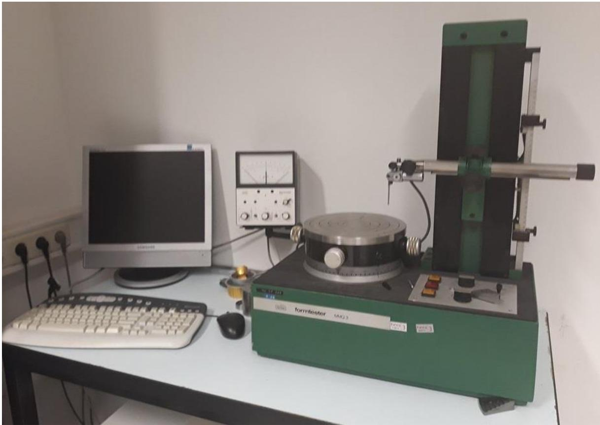
Slika 10 Mjerni sustav za ispitivanje kružnosti
