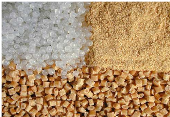
Slika 20. Polietilenske granule, drveno brašno i granule drvno-plastičnog kompozita
