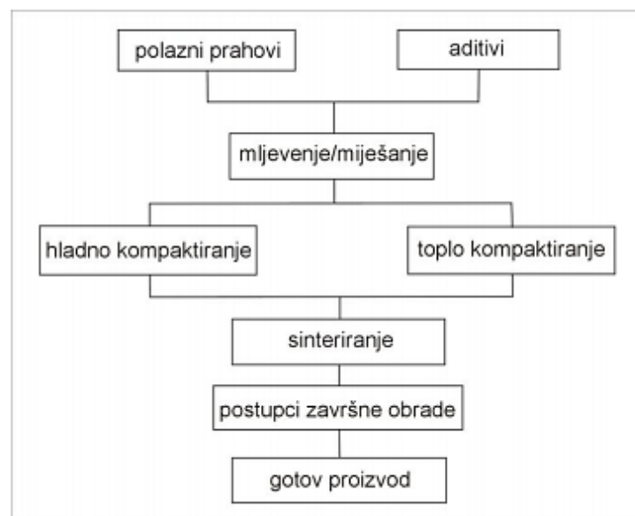
Slika 11. Tijek operacija konvencionalnih postupaka metalurgije praha [4]
