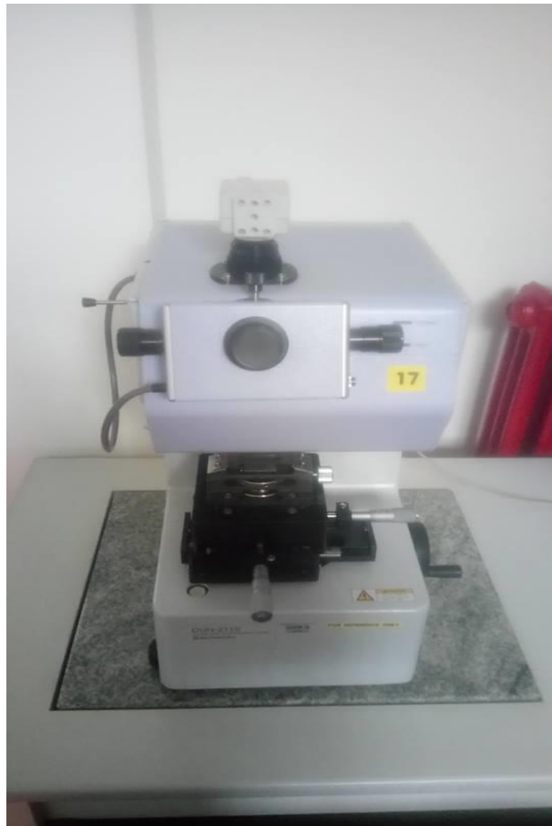
Slika 23. Tvrdomjer Shimadzu DUH 211 S
