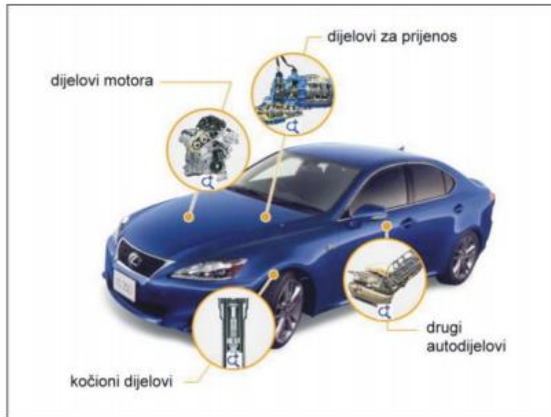
Slika 14. Primjena metalurgije praha u automobilskoj industriji [13]
