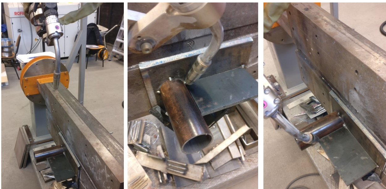
Slika 36. Zavarivanje kod drugog položaja pozicionera
