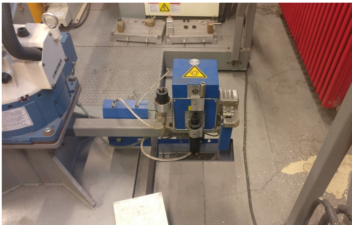
Slika 30. Sklop za čišćenje pištolja za zavarivanje
