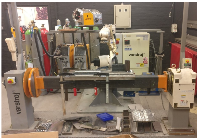
Slika 22. Konfiguracija robotske stanice u Laboratoriju za zavarivanje
