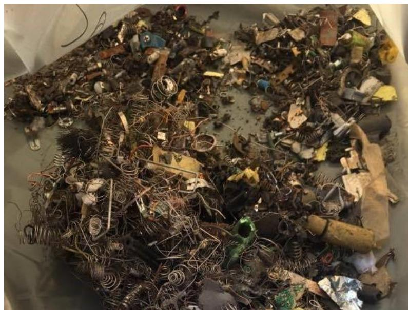
**Slika 20. Dobivena frakcija čelika i magneta**
