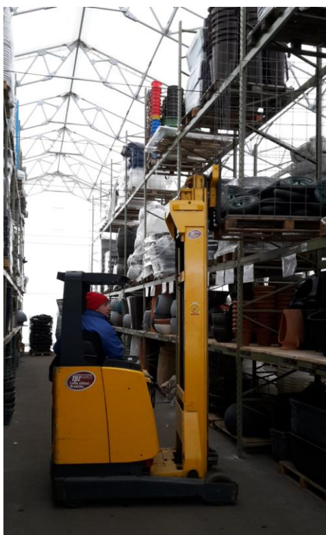
Slika 57. Izuzimanje proizvoda pomoću regalnog viličara
