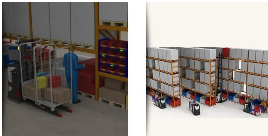
Slika 40. Primjena AGV-a u komisioniranju [41]
