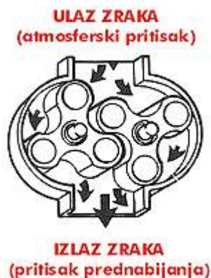
Slika 8. Shematski prikaz rada Rootsovog Rootsovog punjača s ravnim trokrakim rotorima oblika
