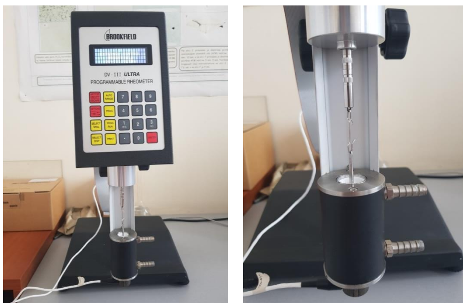
Slika 31. Rotacijski viskozimetar Brookfield DV-III Ultra i detalj lijevo (komora za uzorak)
