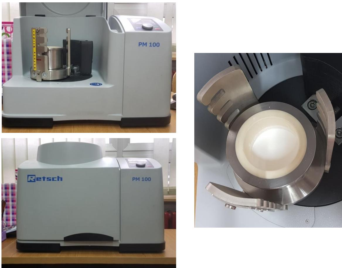
**Slika 28.** Planetarni kuglični mlin Retsch PM 100 izvana (lijevo gore),
