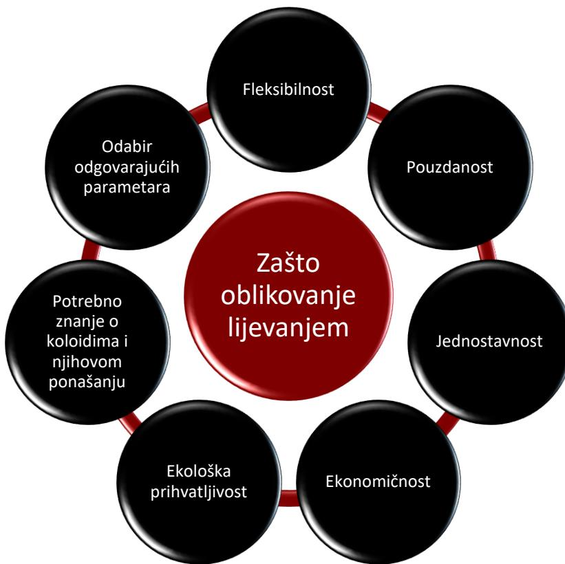
**Slika 14.** Razlozi primjene oblikovanja keramike lijevanjem suspenzija [prema 23]
