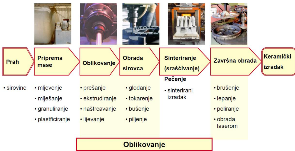
Slika 9. Bitne faze u procesu proizvodnje keramike [7]
