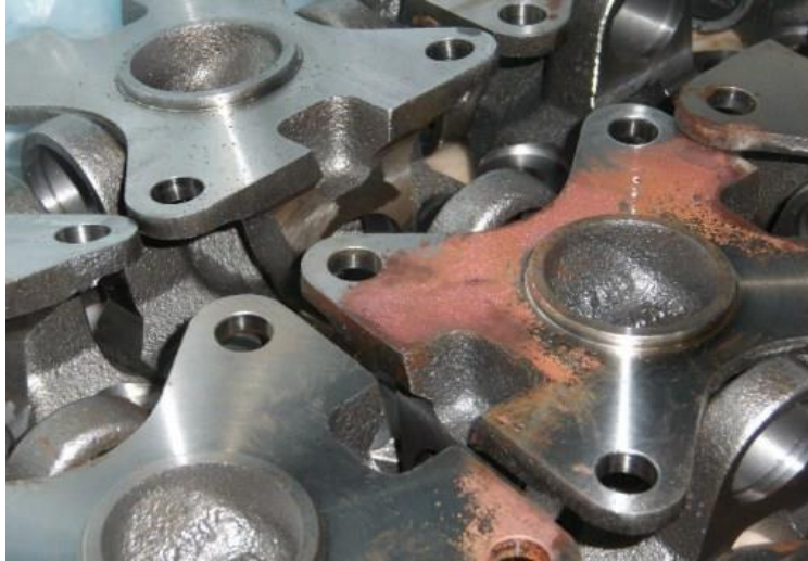
Slika 21. Korozija uskladištenih proizvoda
