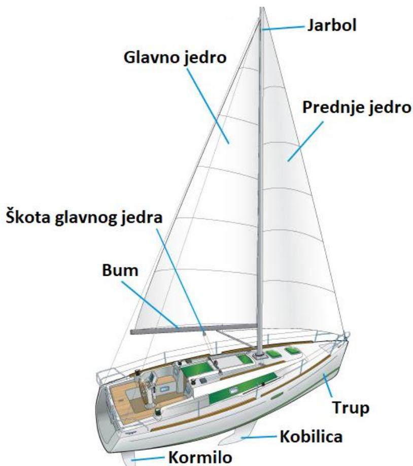
Slika 1.1 Dijelovi jedrilice [20]
