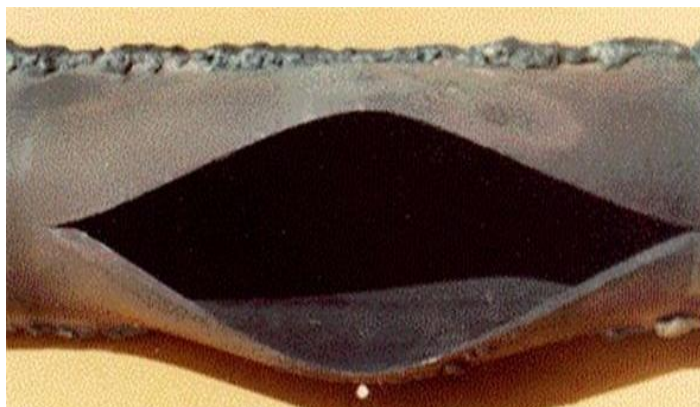
Slika 7: Pukotina kod vremenski kraće izloženosti nepovoljnim uvjetima [10]
