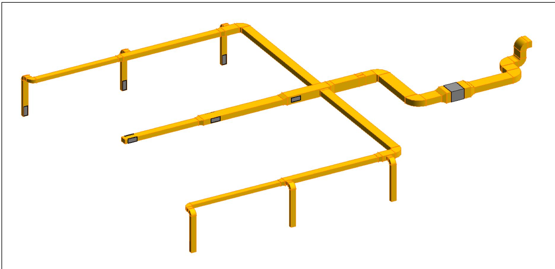
Slika 36. 3D prikaz odsisne ventilacije podzemne garaže
