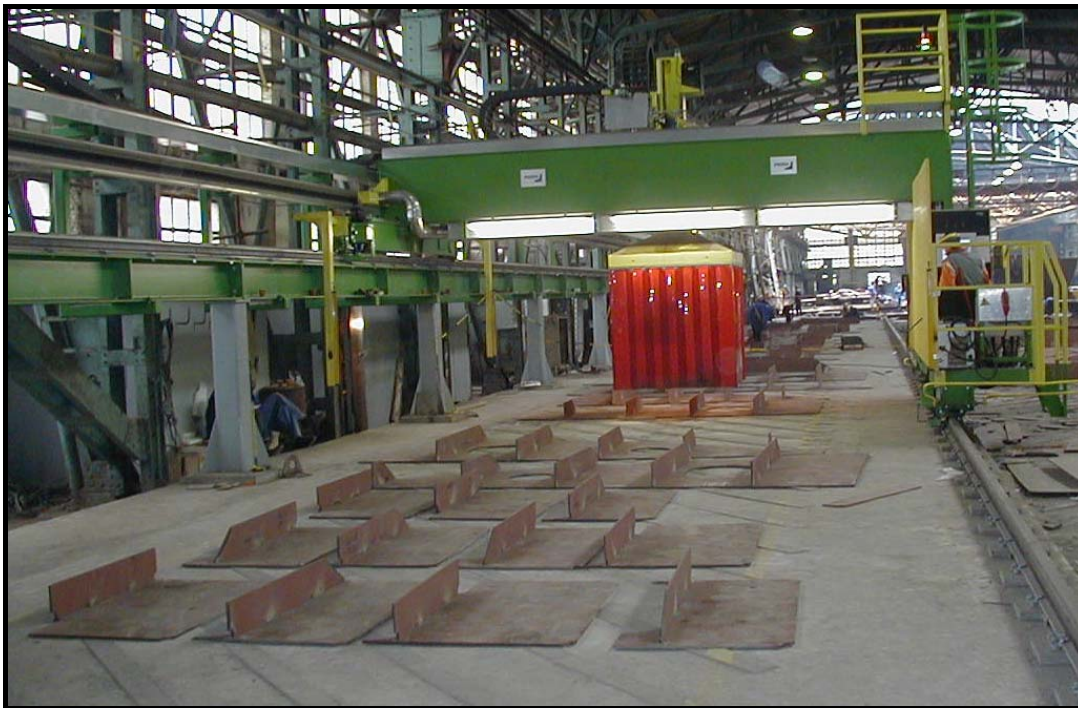
Slika 5. Robotizirana linija za izradu podsklopova
