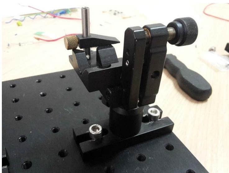
Slika 30. V-stezaljka za postavljanje lasera
