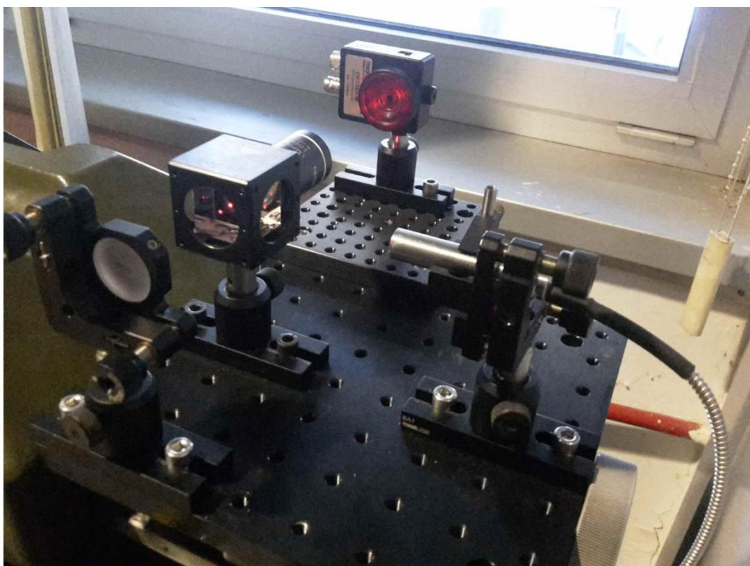
Slika 35. Nepomični dio interferometra postavljen na postojeći uređaj
