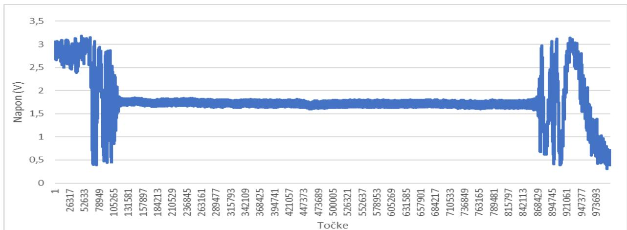
Na grafu [Graf 3] prikazan je cijeli snimljeni signal, snimanje je vršeno brzinom uzorkovanja od 200kS/s, a započelo je prije kretanja pomičnog kraka i završilo nakon zaustavljanja pomičnog kraka interferometra. Dok je istovremeno komercijalnim interferometrom za mjerenje pomaka izmјeren pomak od 8,418 mm.
