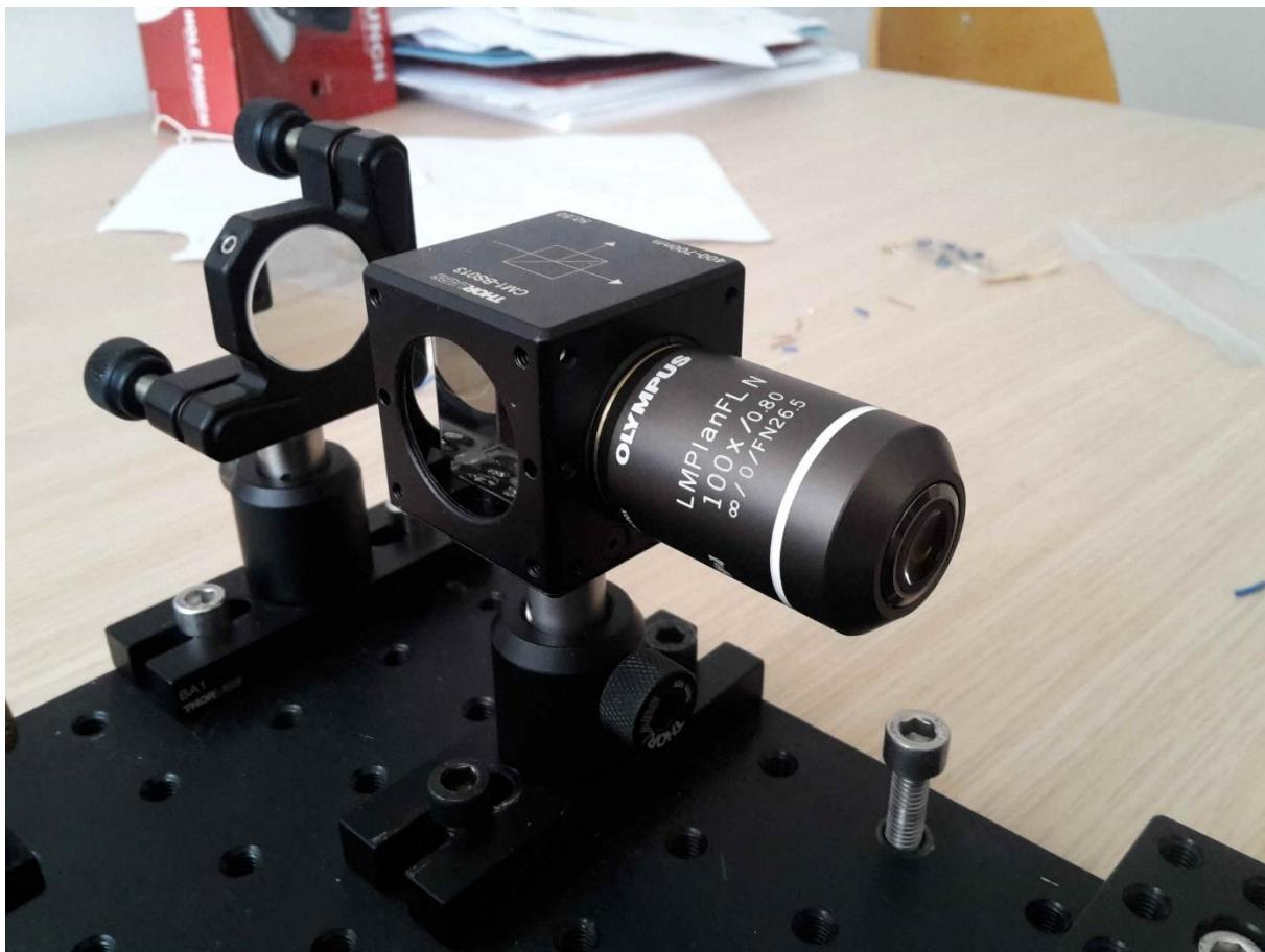
**Slika 33. Mikroskopski objektiv ugrađen na kućište razdjelnika snopa**
