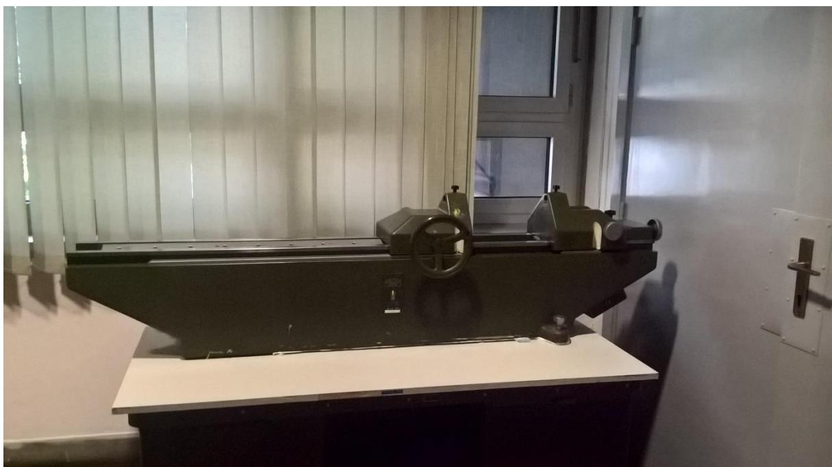
Slika 20. Postojeći jednoosni mjerni uređaj „Carl Zeiss“
