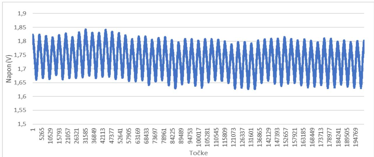
Na grafu[Graf 4] prikazan je odsječak snimljenog signala s interferometra između 200000 i 400000-og uzorka (200000 uzorka) što uz brzinu uzorkovanja od 200kS/s predstavlja period od 1 s.
