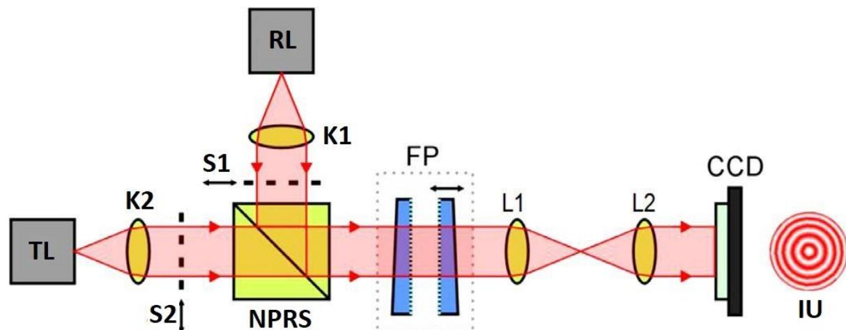
Slika 12. Fabry-Perot interferometar[16]
