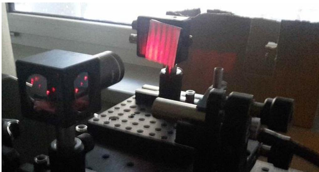
**Slika 38. Interferencijske linije na fotodetektoru**
