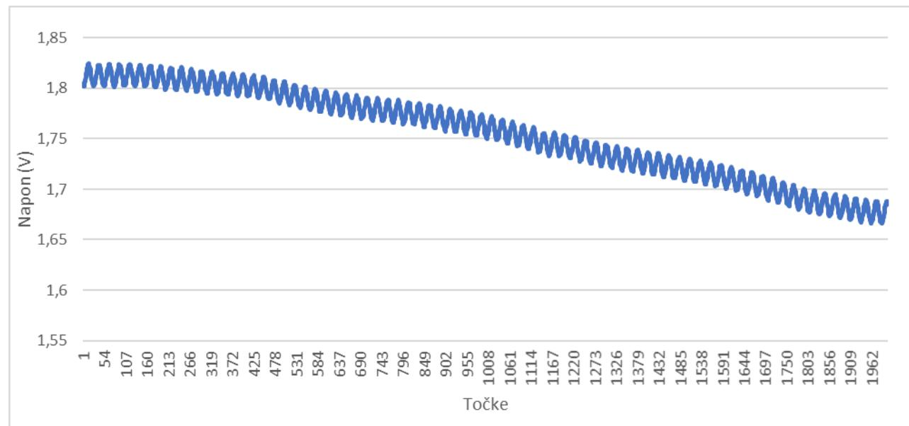
Tek analiziranjem još kraćih perioda uzorkovanja на grafovima[Graf 5] и [Graf 6] вidi се signal fotodetektora superponiran на signal elektroenergetske mreže.
