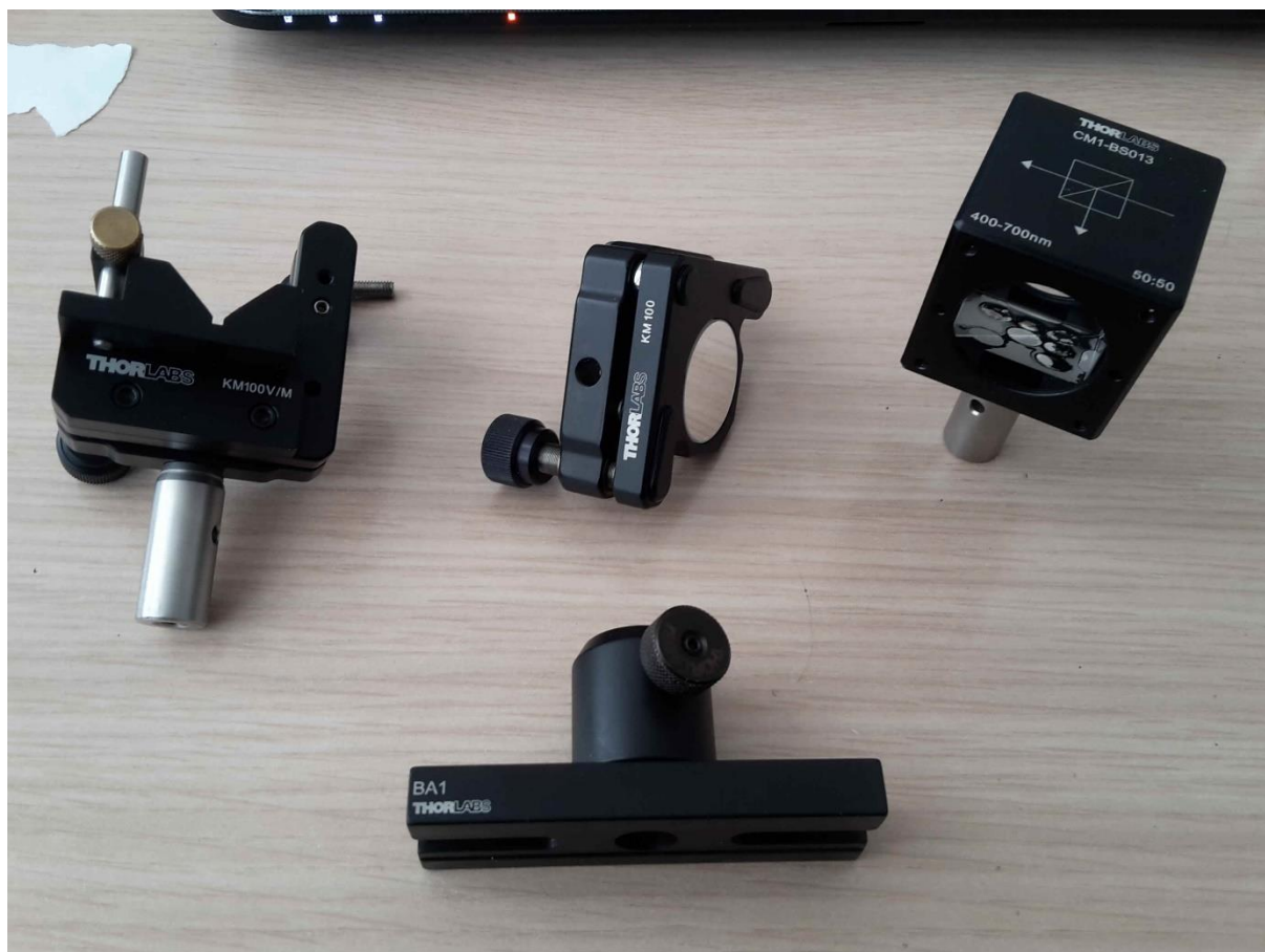
Slika 22. Thorlabs-ovi moduli korišteni pri izradi interferometra
