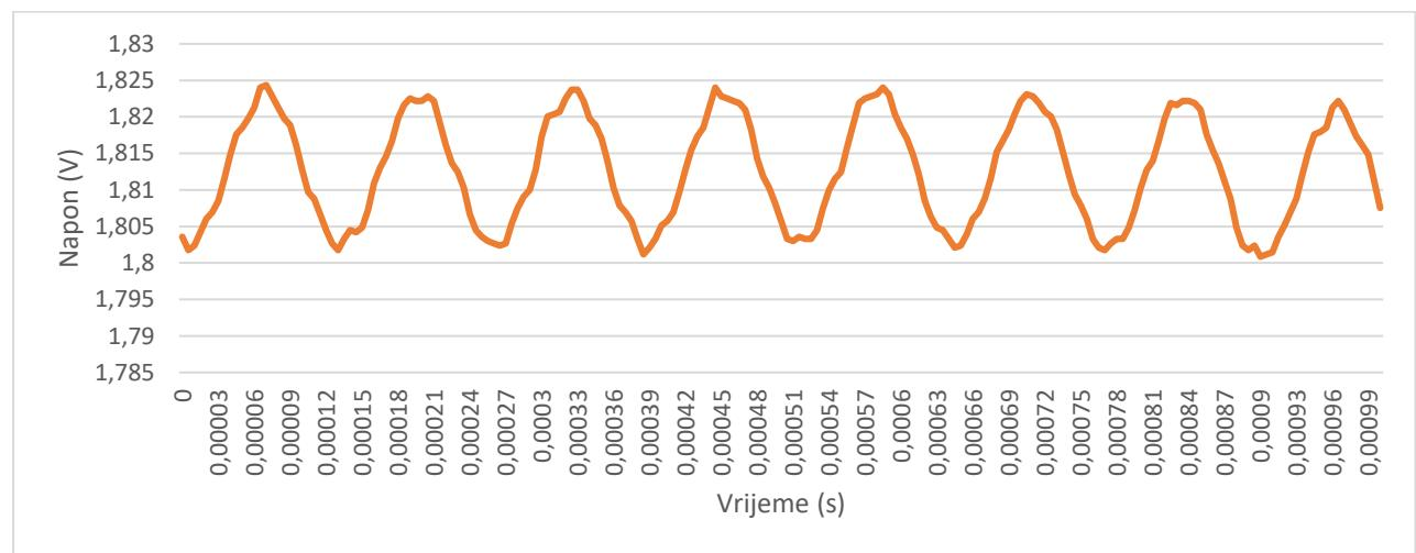
Analizom još kraćeg perioda uzorkovanja na grafovima [Graf 7] i [Graf 8] vidimo signal sa fotodetektora, ovdje se može izbrojati 8 registriranih prelazaka interferencijskih linija preko fotodetektora u periodu od 0,01s sto odgovara frekvenciji od 8kHz sto objašnjava zašto nije bilo moguće snimiti pokret uređajem PM100USB uz maksimalnu frekvenciju uzorkovanja od 100 S/s.
