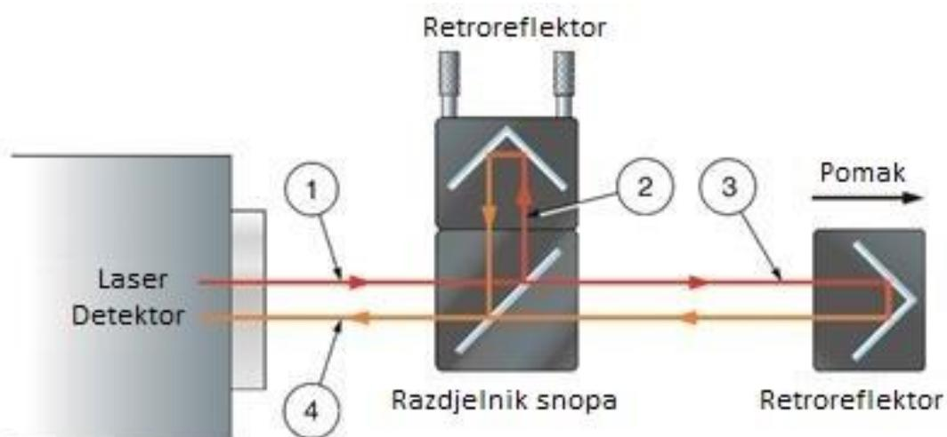
Slika 6. Michelsonov interferometar za mjerjenje pomaka opremljen retroreflektorima [13]
