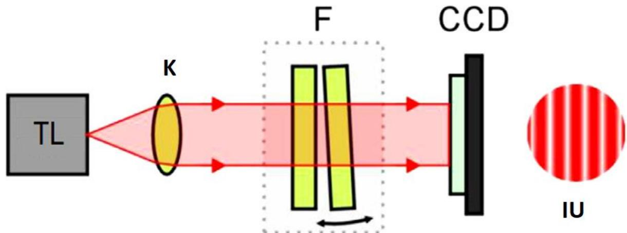
Slika 13. Fizeau interferometar[16]
