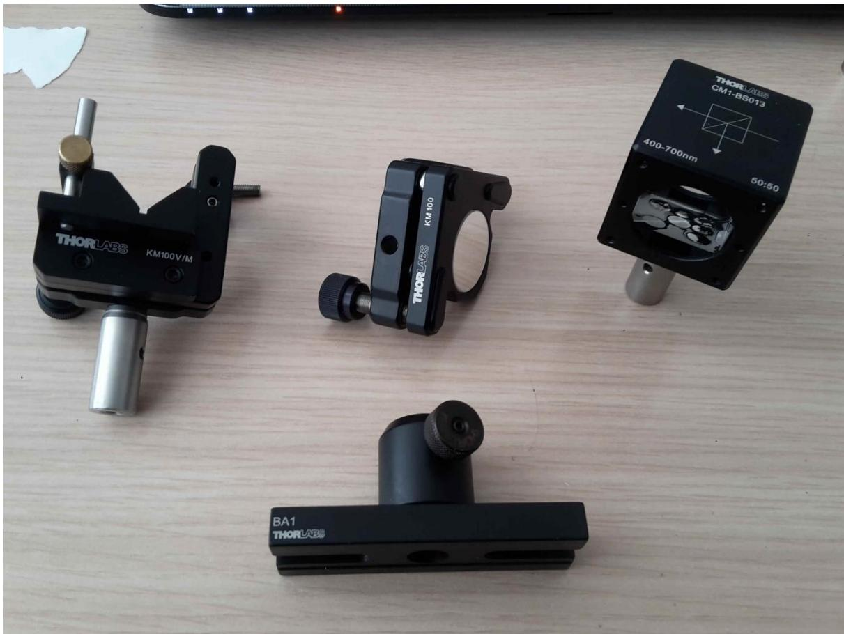
Slika 22. Thorlabs-ovi moduli korišteni pri izradi interferometra
