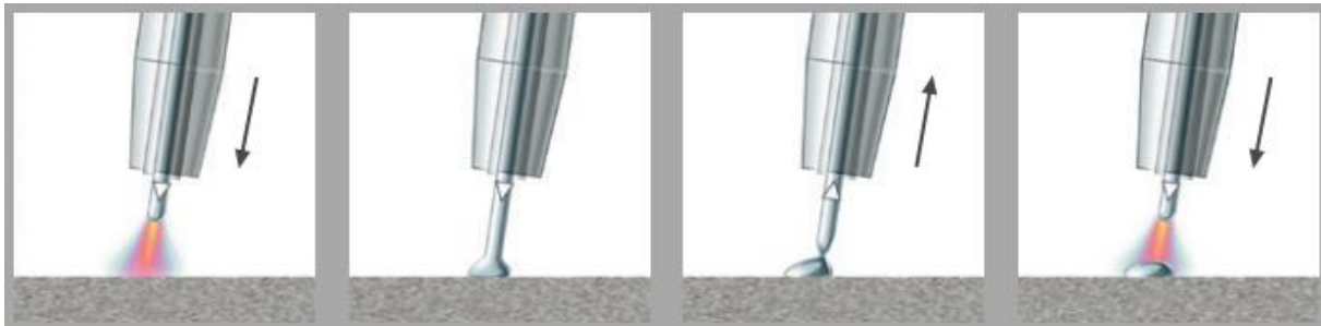
Slika 14. CMT postupak zavarivanja [26]
