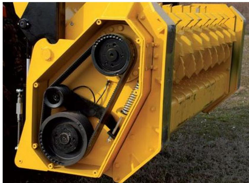
**Slika 31 Dvostruki prijenos remenima i automatsko zatezanje remena [9]**
