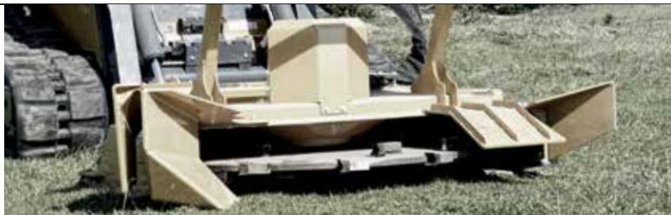
Slika 64 Malčer sa diskom poduzeća Diamon Mowers [13]
