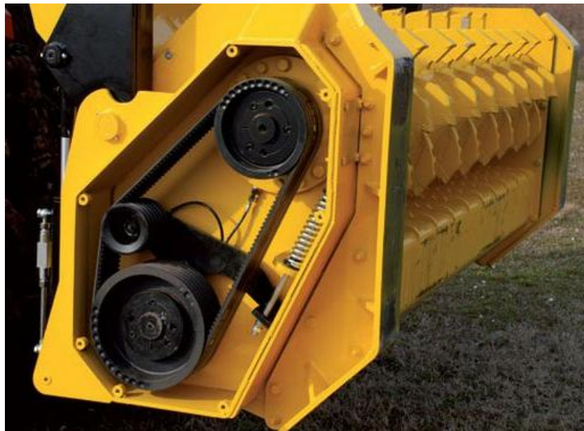
Slika 31 Dvostruki prijenos remenima i automatsko zatezanje remena [9]
