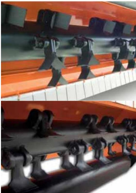
**Slika 38 Rotor sa čekićima ili oštricama [10]**
