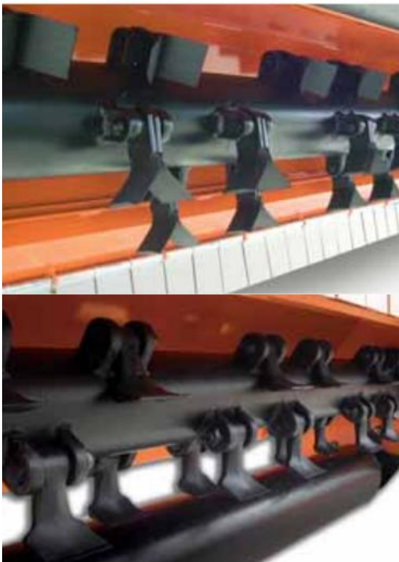
Slika 38 Rotor sa čekićima ili oštricama [10]
