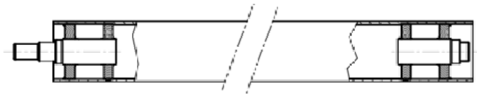
Slika 27 Rotor sa duplom prirubnicom [9]
