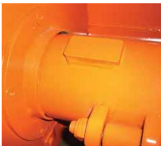
Slika 37 Ležajevi rotora u stranicama [10]
