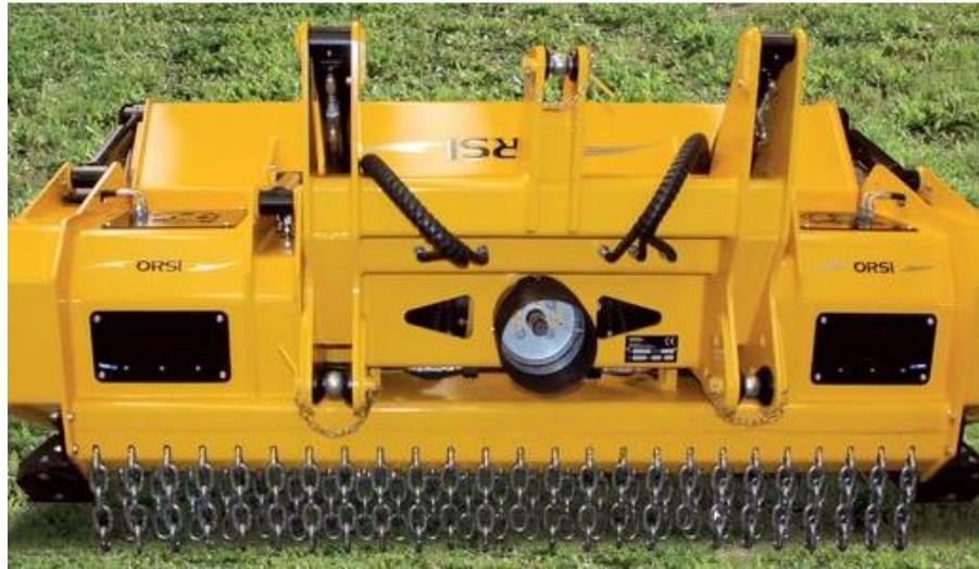
**Slika 30 Super Forrest malčer - priključak za traktor [9]**
