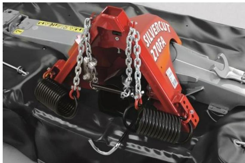
**Slika 11 Priključak za traktor Silvercut disc 300 F [8]**
