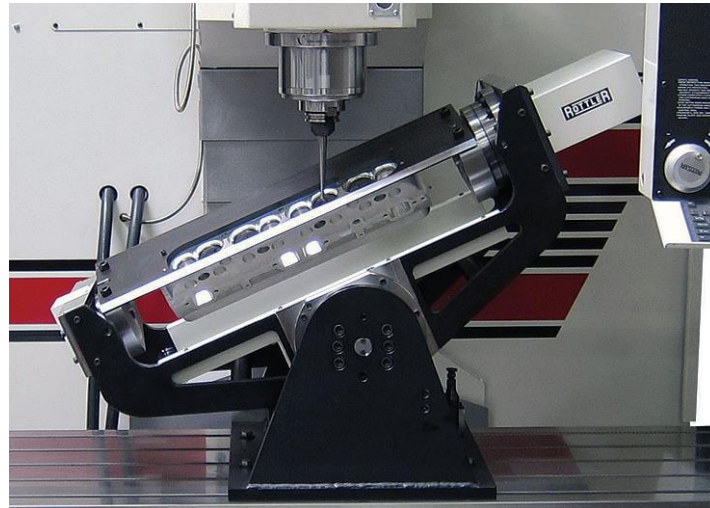
Slika 27. Proces obrade na stolu s dvije nagibne osi [31]
