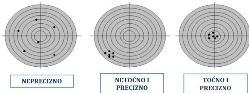
Slika 12 Razlika između točnog i preciznog [11]
