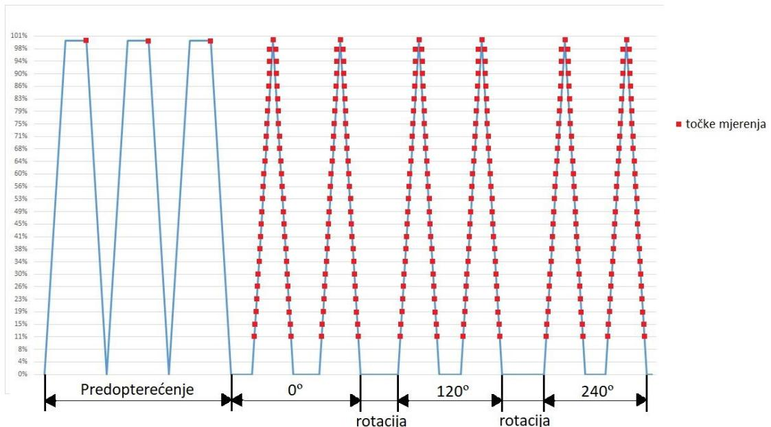
Slika 21 Shematski prikaz opterećenja u 3. fazi eksperimentalnog rada
