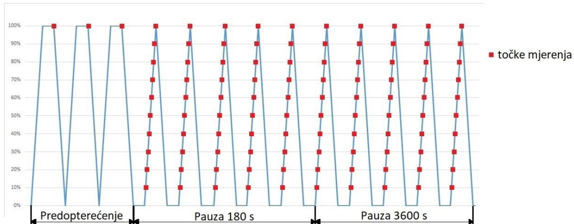
Slika 19 Shematski prikaz opterećenja u 1. fazi eksperimentalnog rada
