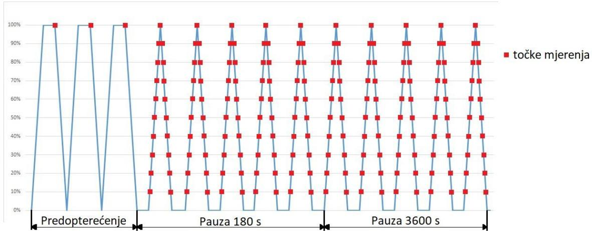
Slika 20 Shematski prikaz opterećenja u 2. fazi eksperimentalnog rada
