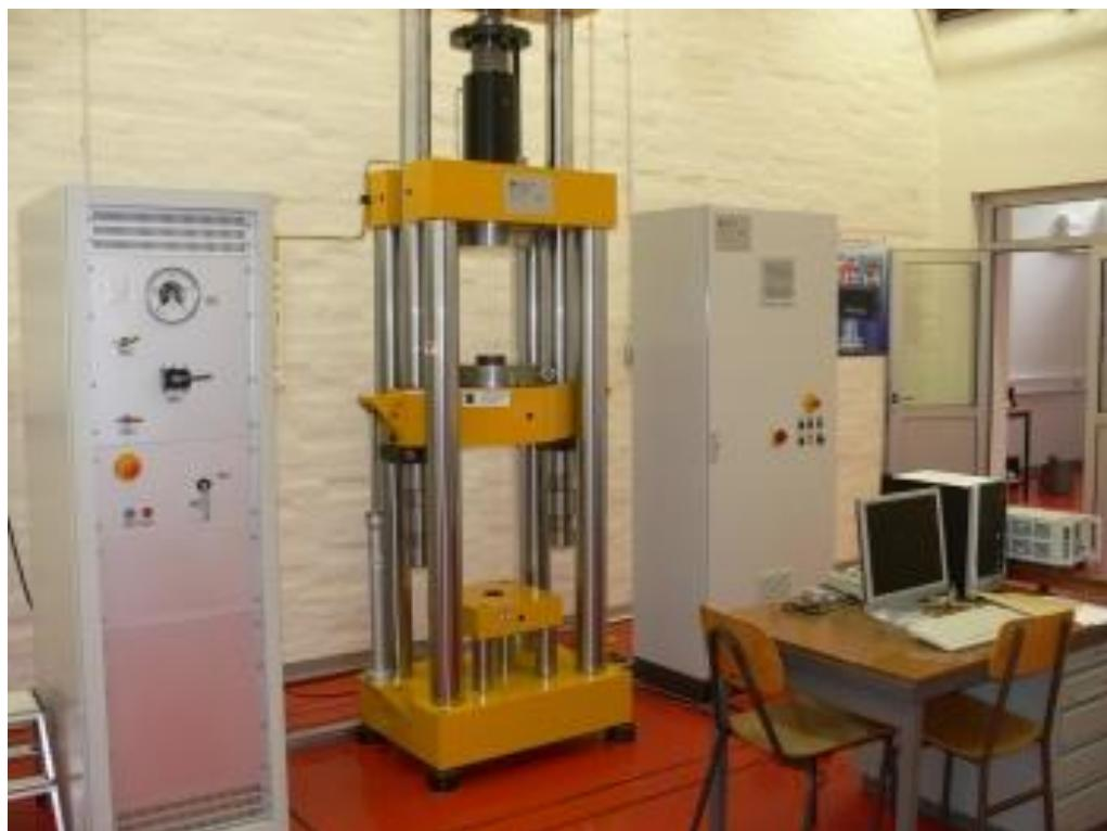
Slika 14 Referentni etalon sile LIMS-a [16]
