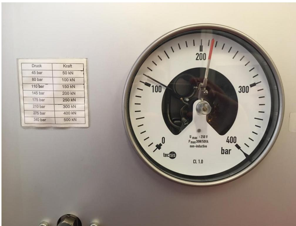
Slika 23 Mjerna skala za ograničenje opterećenja
