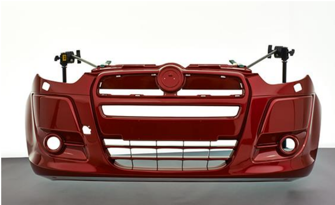
Slika 2.24. Prednji branik automobila (postupak SLA) [37]
