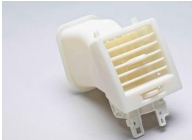
Slika 2.23. Kanali klimatizacije automobila (postupak SLS) [36]
