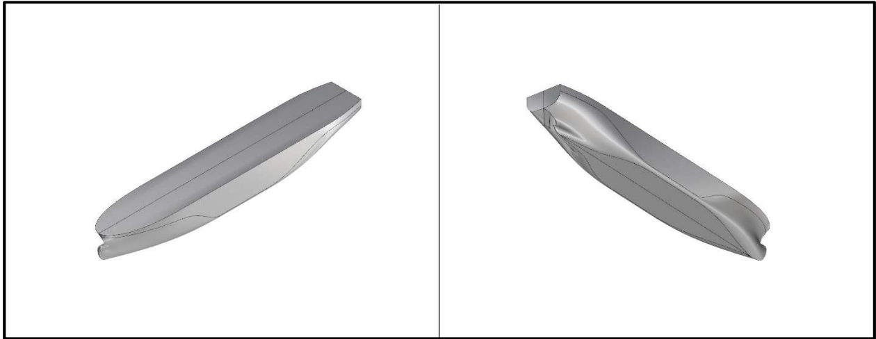
Slika 15. 3D model trupa broda s kormilom
