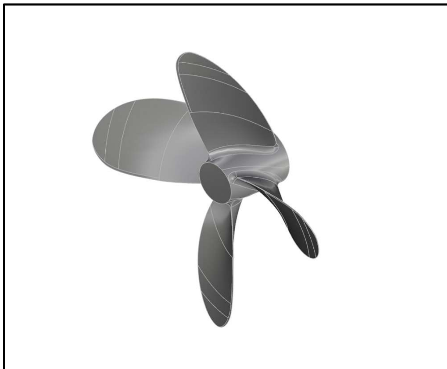
Slika 3. 3D model brodskog vijka u programskom paketu Rhinoceros
