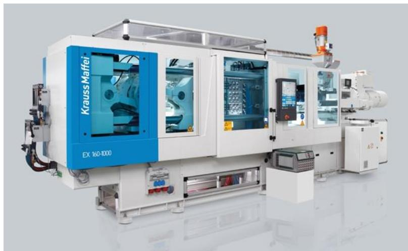
Slika 3.1. Stroj za injekcijsko prešanje [34]
