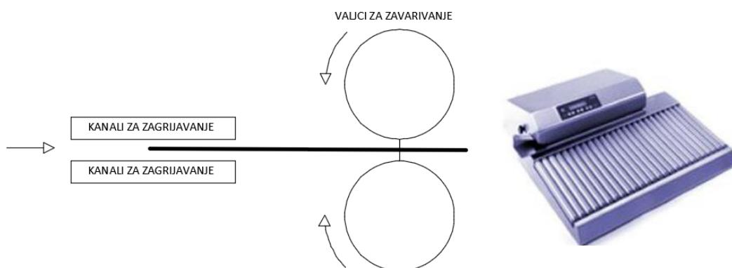
Slika 4.7. Uređaj za zavarivanje s pokretnim valjcima (rotirajućim) [46]
