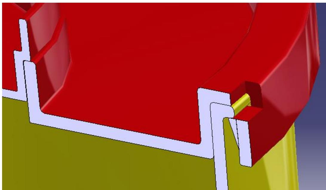
Slika 6.4. Poklopac u zahvatu sa cilindričnim spremnikom
