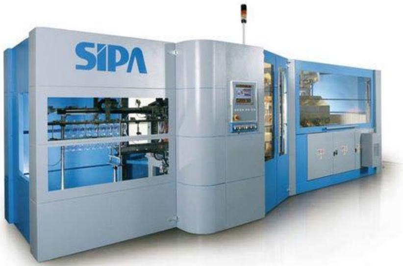
**Slika 5.2. Stroj za ekstruzijsko puhanje [25]**
