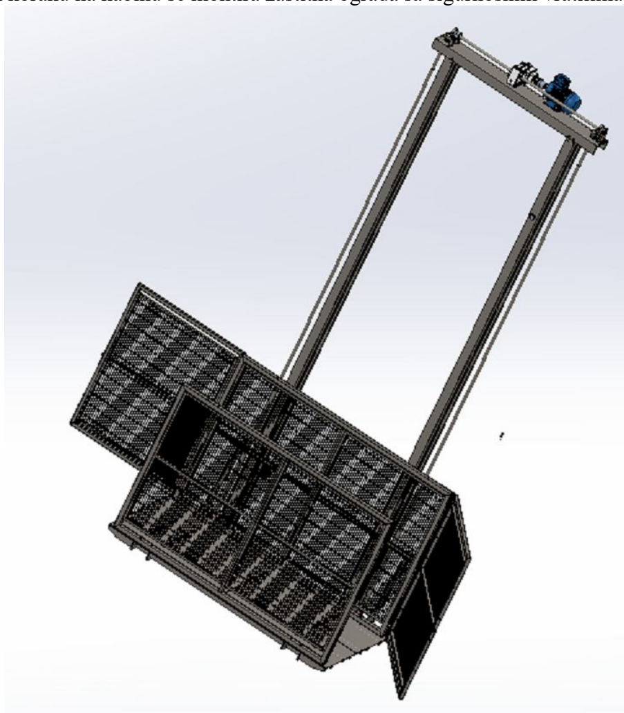
Slika 8-7 Montirana zaštitna ograda na kabini
