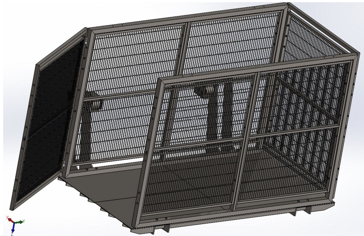
Slika 2-2 izvedba kabina teretne platforme sa vratima , vodilicama i zaštitnom ogradom konstruirana u programskom paketu Solidworks 2017
