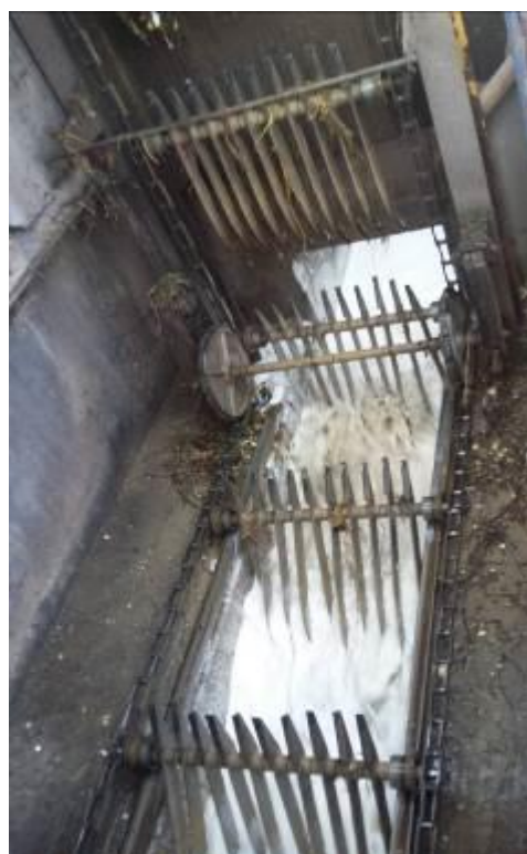
Slika 7. Hidraulički transport šećerne repe [10]
