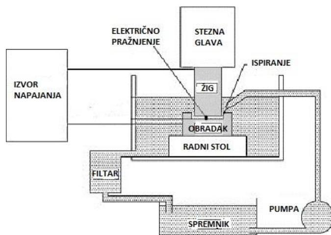
Slika 29. Shematski prikaz uređaja za elektroerozijsku obradu žigom [18]
