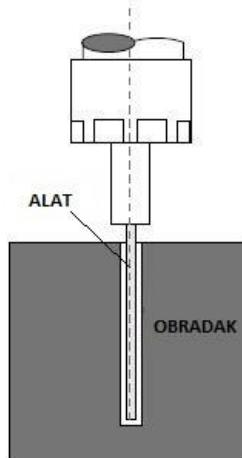
Slika 31. Elektroerozijsko bušenje [2]
