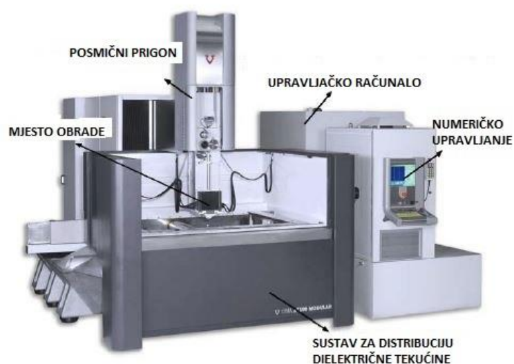
Slika 26. Elementi elektroerozijskog uređaja [2]
