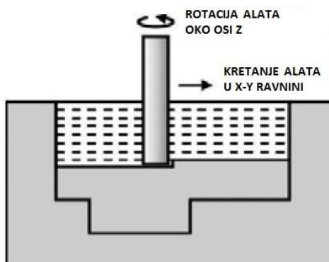
Slika 33. Elektroerozijsko glodanje [2]
