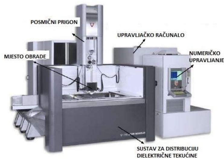
Slika 26. Elementi elektroerozijskog uređaja [2]
