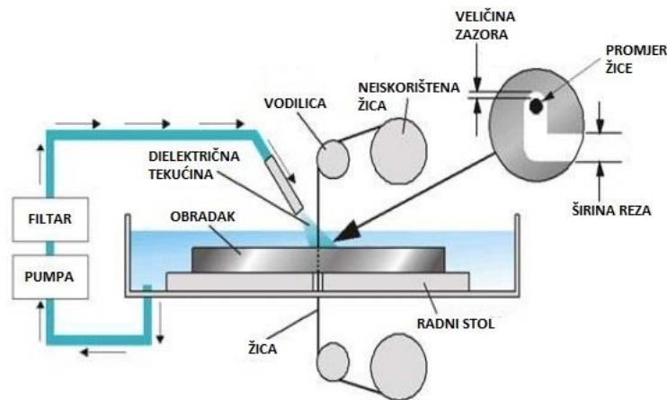
Slika 25. Shema uređaja za elektroerozijsko rezanje [17]
