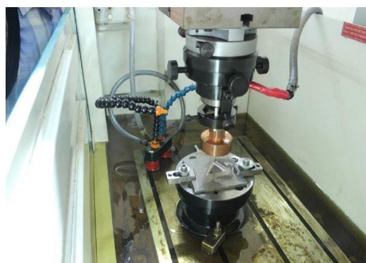
Slika 19 Primjer radnog stola uređaja za elektroerozijsku obradu žigom [9]
