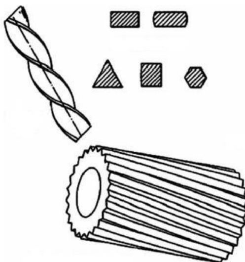
Slika 28. Razni oblici poprečnog presjeka žice [2]
