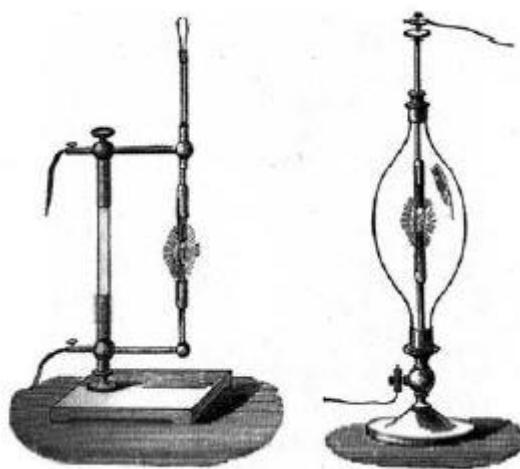
Slika 3. Svjetiljka na principu električnog pražnjenja [1]
