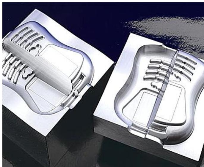
**Slika 30. Primjer izratka elektroerozijskom obradom žigom [19]**
