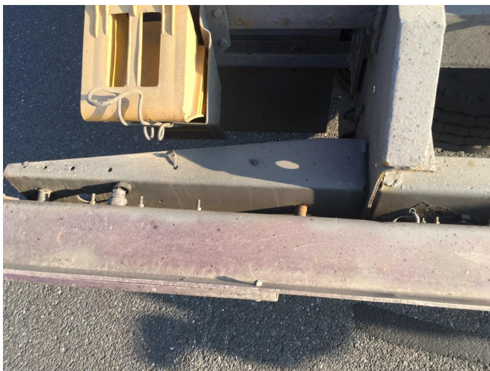
Slika 4.9. Prikaz savijenog zadnjeg odbojnika i popucanih vijaka
