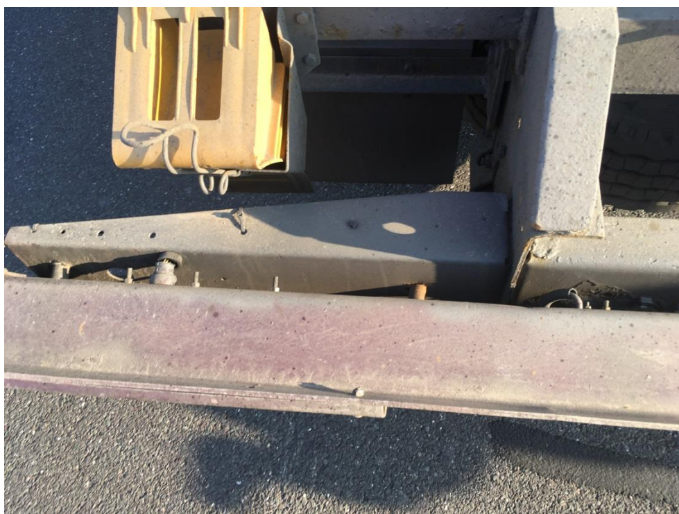
Slika 4.9. Prikaz savijenog zadnjeg odbojnika i popucanih vijaka
