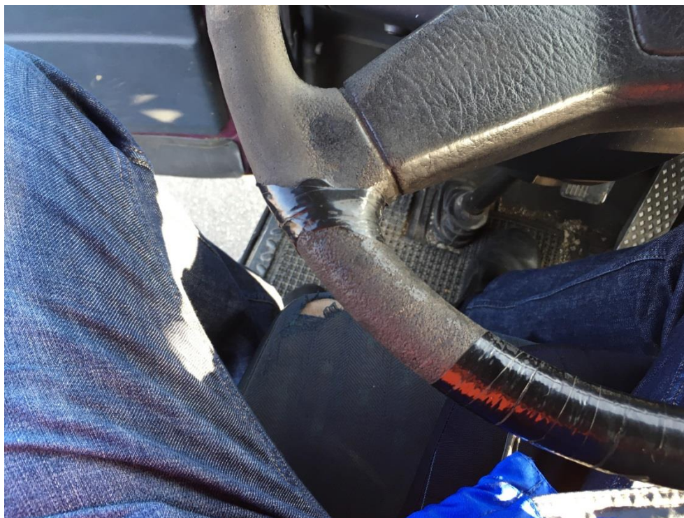
Slika 4.8. Prikaz oštećenja na oblozi kola volana
