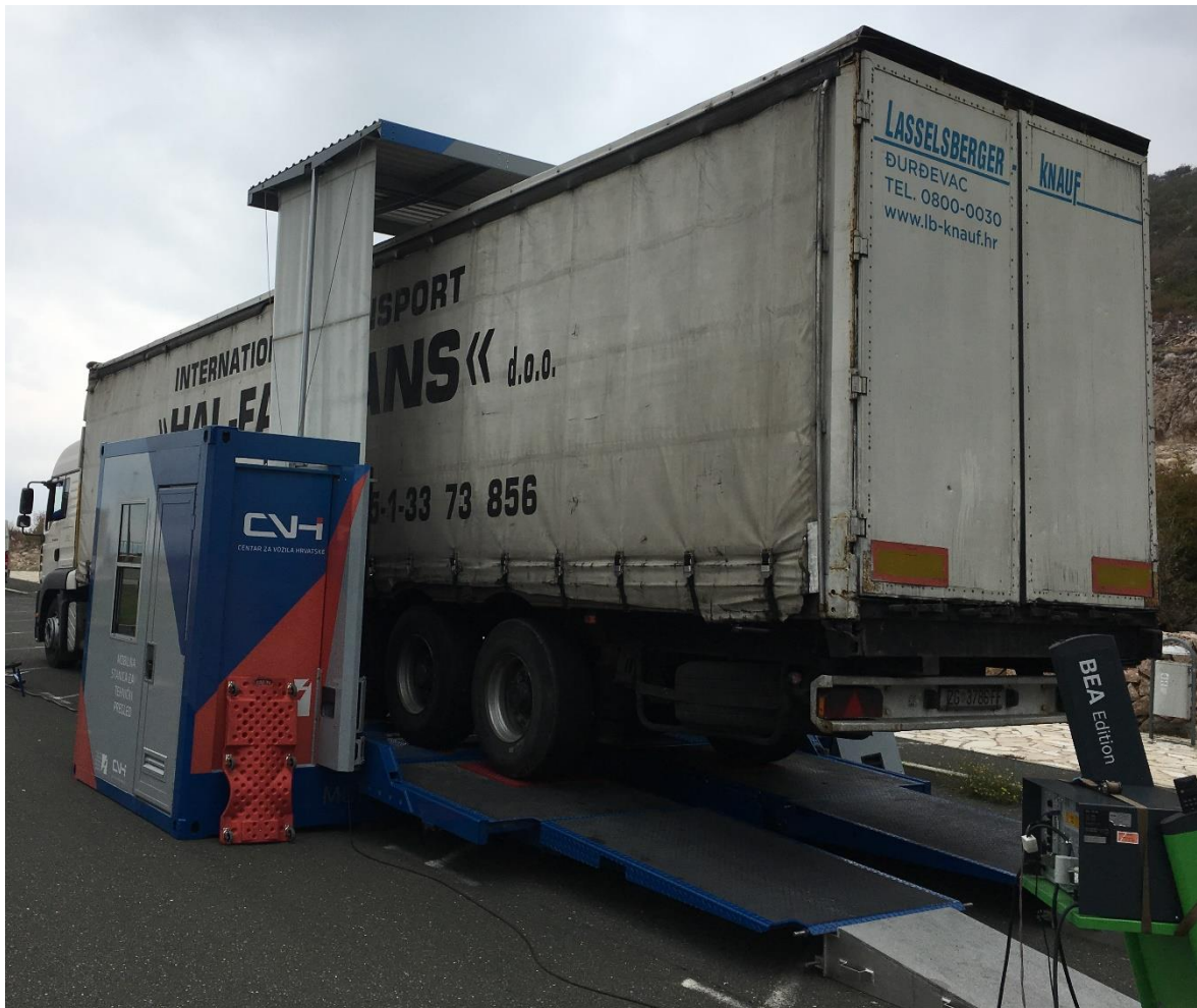
Slika 4.2. MAN-ov tegljač na valjcima
