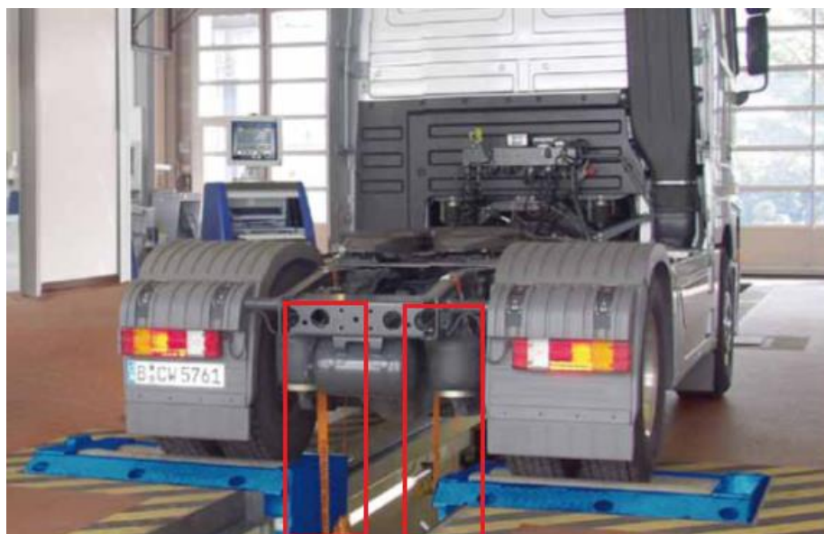
Slika 24. Sidrište na kućištu diferencijala[11]
