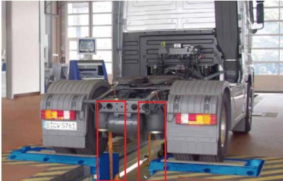
Slika 24. Sidrište na kućištu diferencijala[11]
