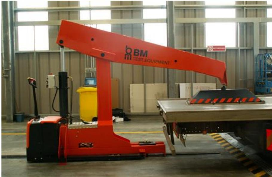
Slika 9. Mobilni uređaj za opterećivanje tovarnog prostora vozila[7]
