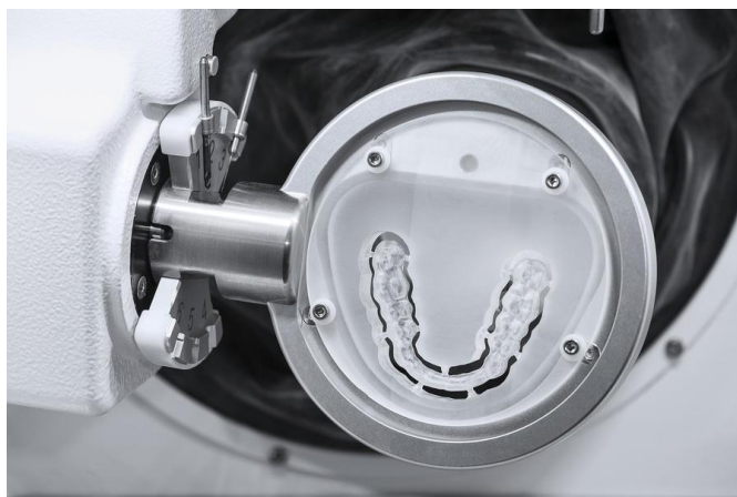
Slika 12. Okluzijska udlaga izrađena glodanjem diska polimernog materijala [14]
