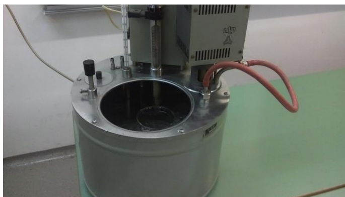
Slika 41. Uređaj za grijanje vode
