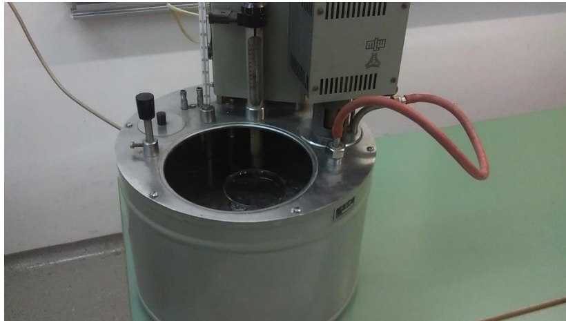
Slika 54. Uređaj za grijanje vode
