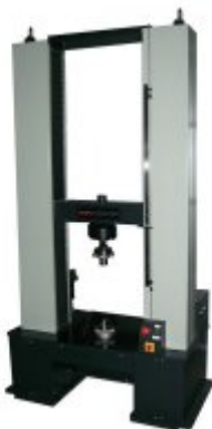
Slika 32. 300 Serija standardnog stroja za ispitivanje na vlak [4]
