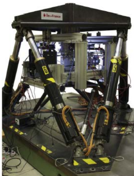
Slika 24. 6-osni stroj s kamerama i DIC [17]
