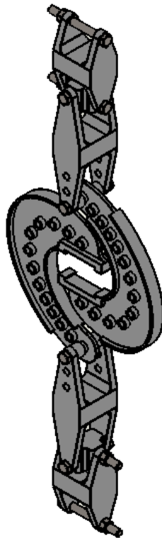
Slika 41. Prostorni prikaz okvirne konstrukcije koncepta Arcan prihvata
