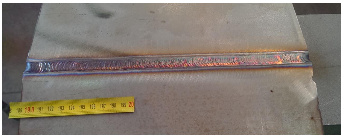
Slika 28. Korijen zavarenog spoja ispitnog uzorka 2
