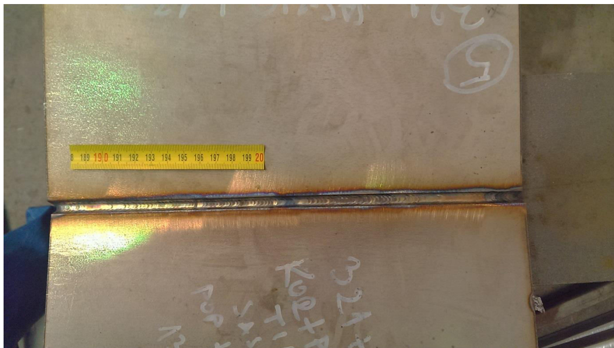
Slika 30. TIG zavarivanje ispitnog uzorka 5
