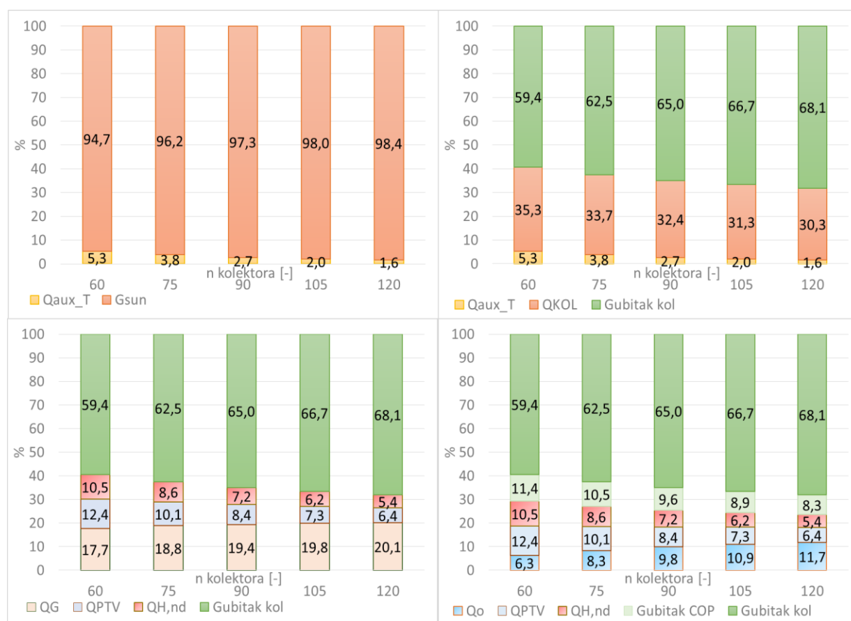
Slika 3.53. Tijek pretvorbe 100% pogonske energije u korisnu energiju, rashladni učin i gubitke sustava
