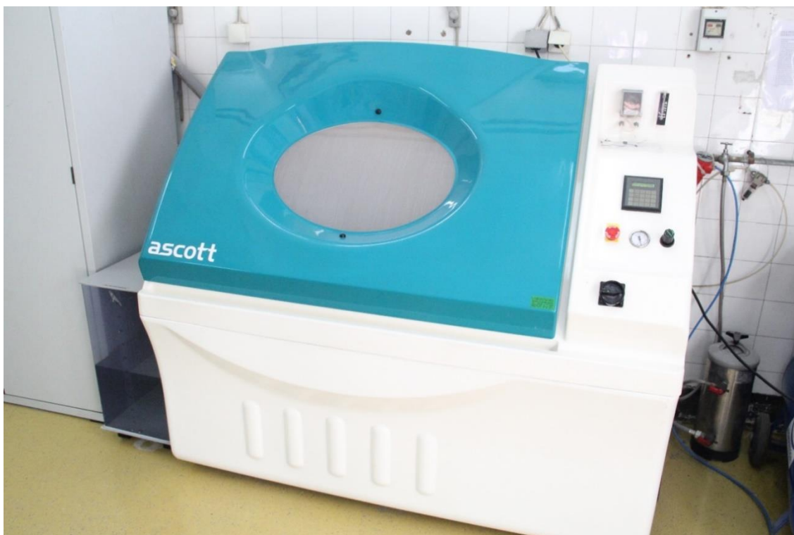
Slika 33. Ispitivanje uzoraka u slanoj komori Ascott S450
