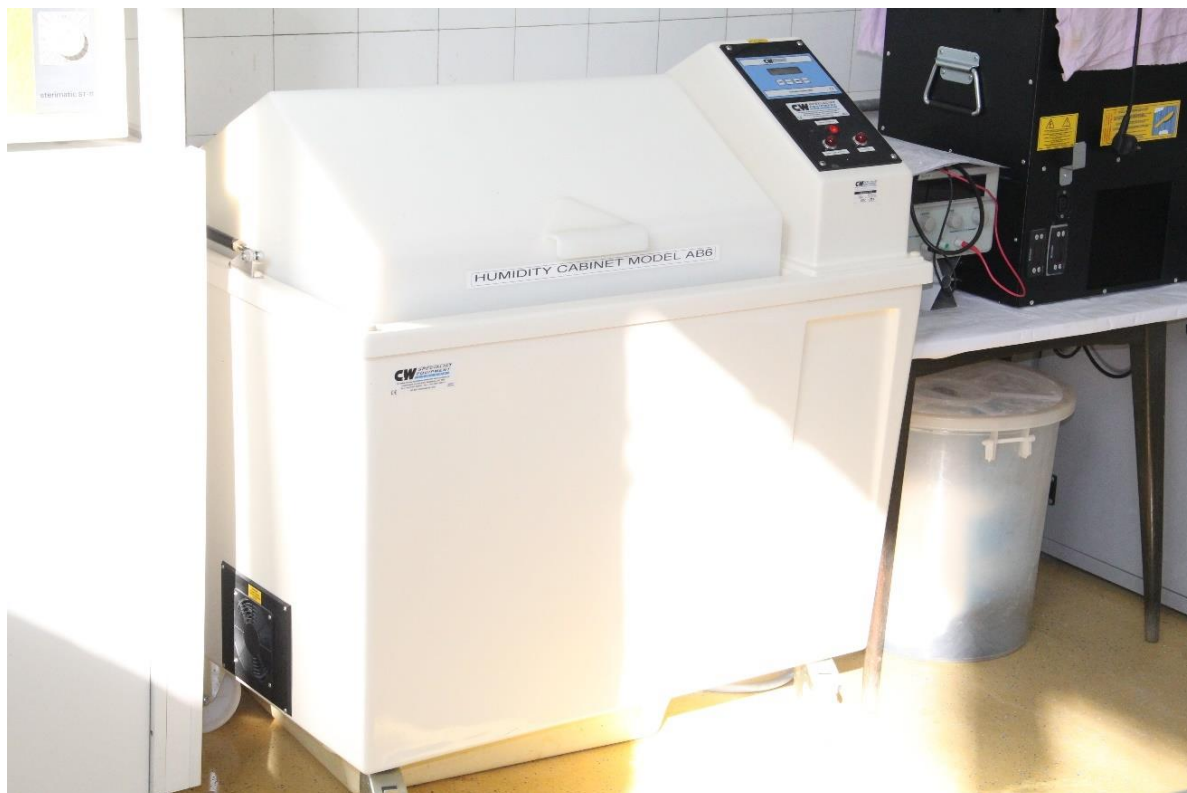
Slika 43. Ispitivanje uzoraka u vlažnoj komori Humidity cabinet model AB6
