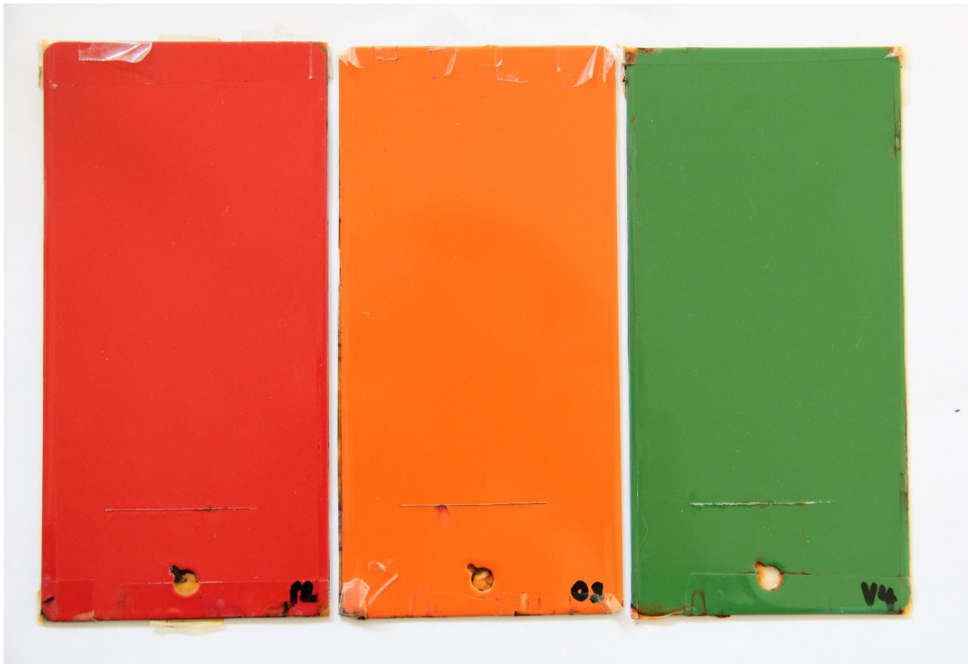
Slika 40. Uzorci nakon 240 sati ispitivanja u slanoj komori
