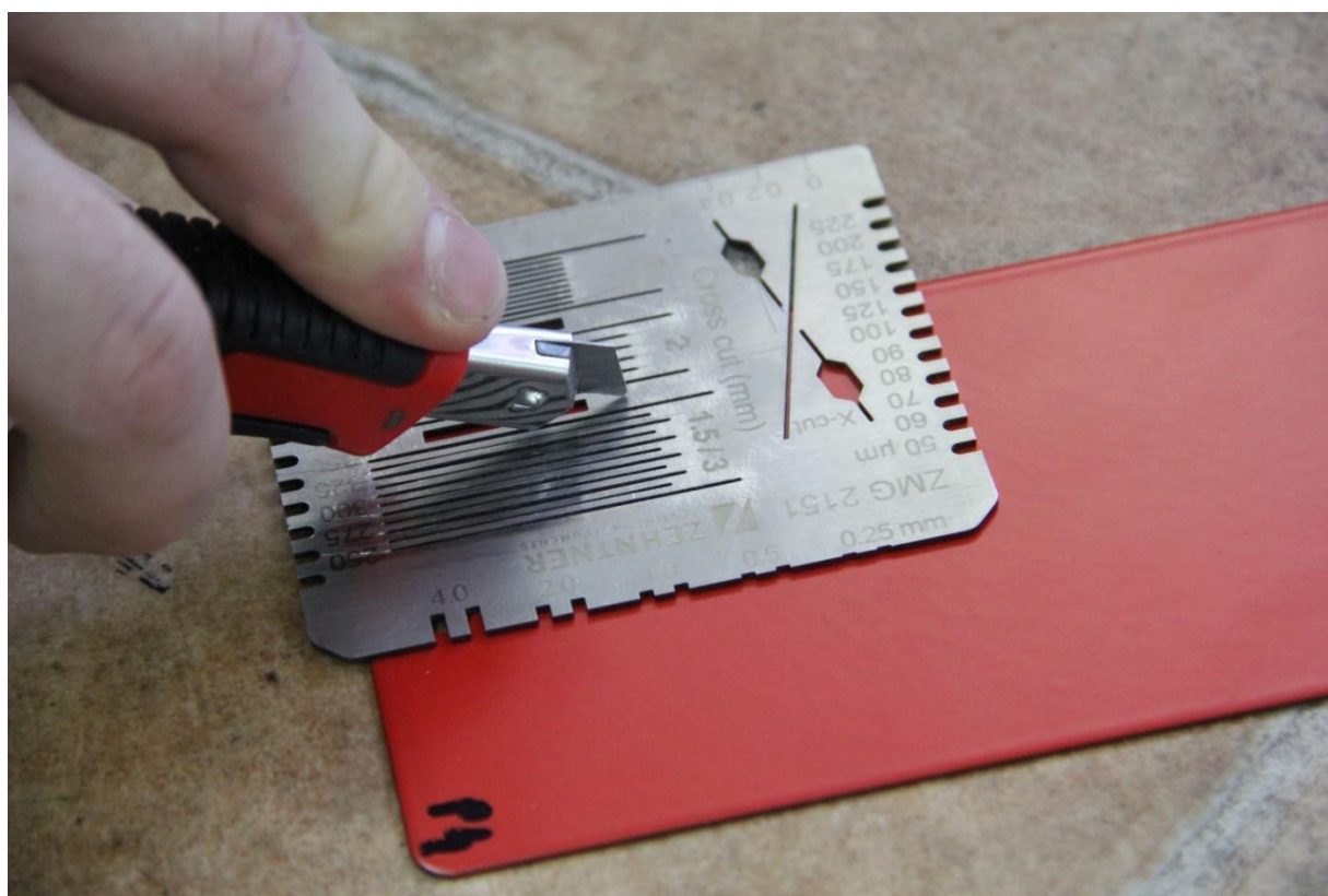
Slika 30. Ispitivanje prionjivosti premaza Cross – cut testom
