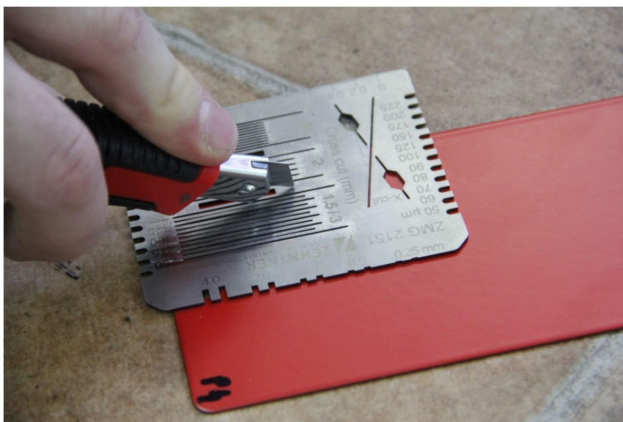
Slika 30. Ispitivanje prionjivosti premaza Cross – cut testom
