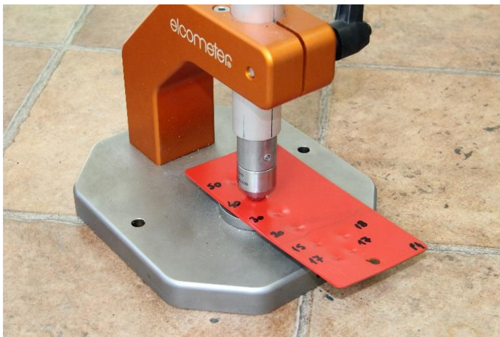
Slika 28. Ispitivanje otpornosti premaza na udar
