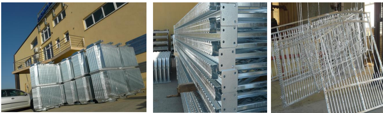
Slika 1. Metalne konstrukcije nakon postupka vrućeg pocinčavanja [9]
