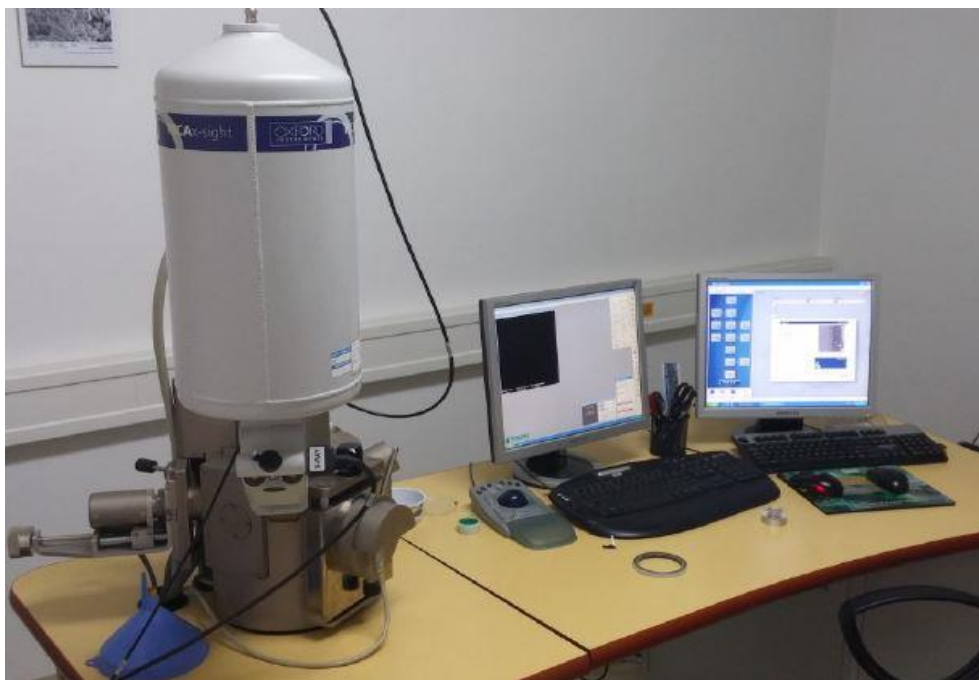
Slika 22. Elektronski mikroskop Tescan VEGA 5136 MM, Laboratorij za materijalografiju, FSB
