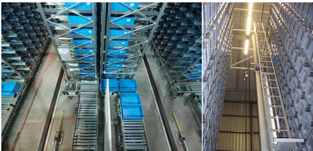
Slika 1. Automatizirani skladišni sustavi s dizalicama unutar prolaza [4]
