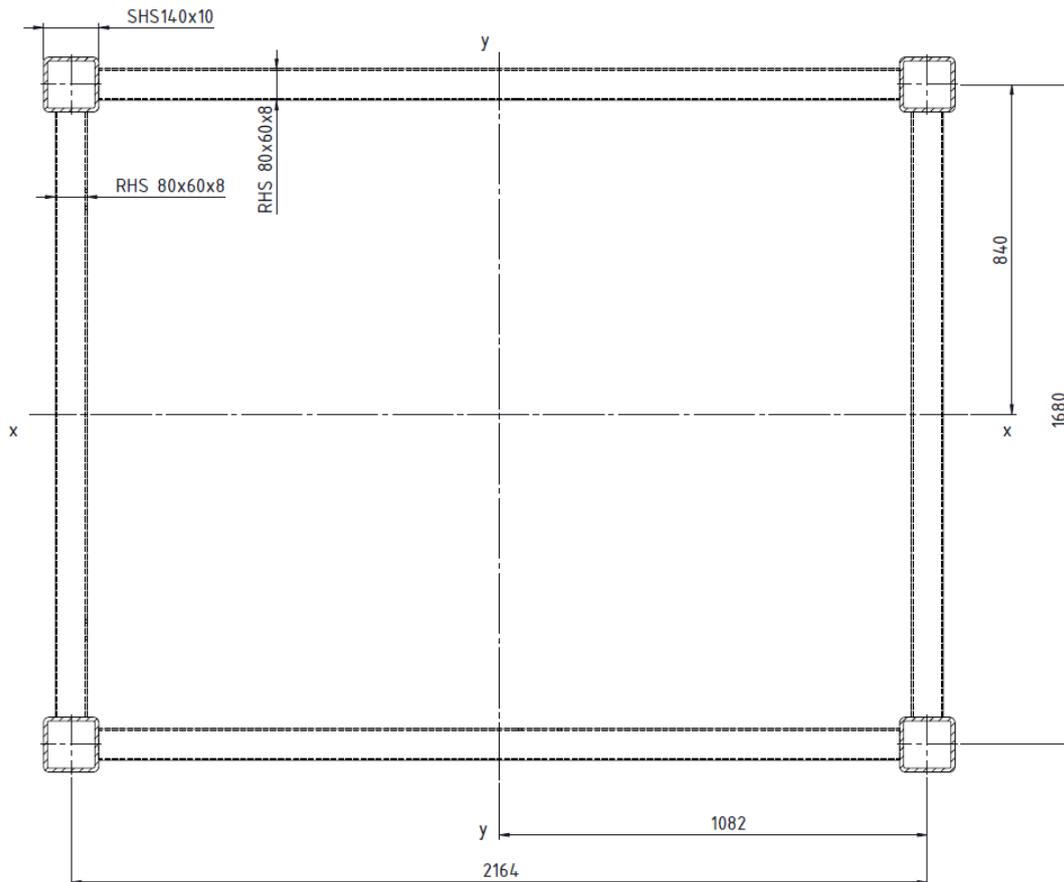
**Slika 48 Horizontalni presjek nosive konstrukcije voznog okna**
