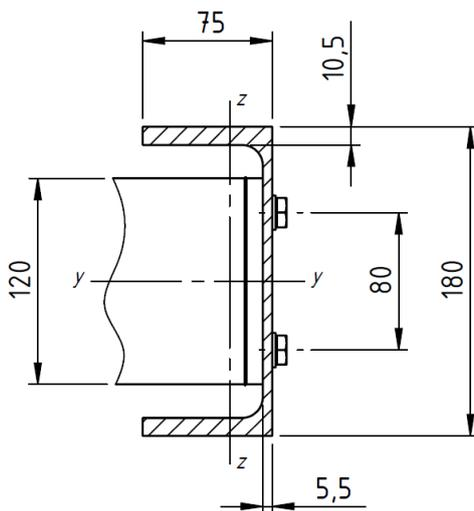
Slika 44 Poprečni presjek stupa nosivog okvira protuutega
