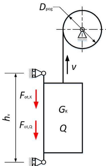
**Slika 3 Shematski prikaz konstrukcijske izvedbe dizala bez protuutega**
