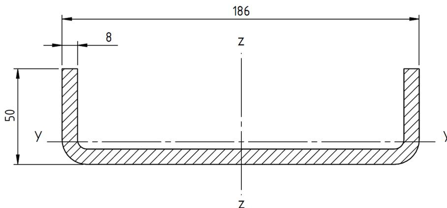
**Slika 39** Poprečni presjek stupa nosivog okvira kabine
