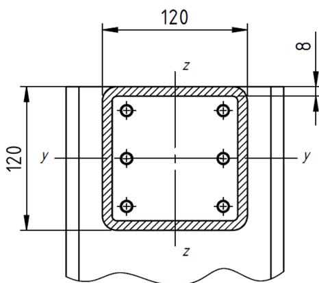
**Slika 43 Poprečni presjek horizontalne grede okvira protuutega**
