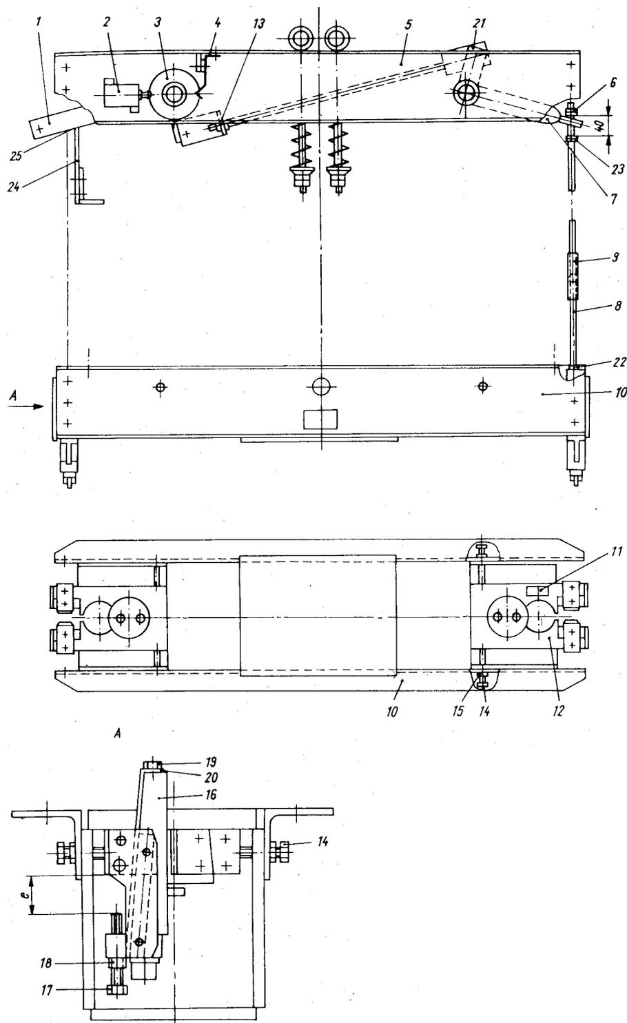
**Slika 23 Polužni mehanizam zaustavnog uređaja s elastičnim elementom [1]**
