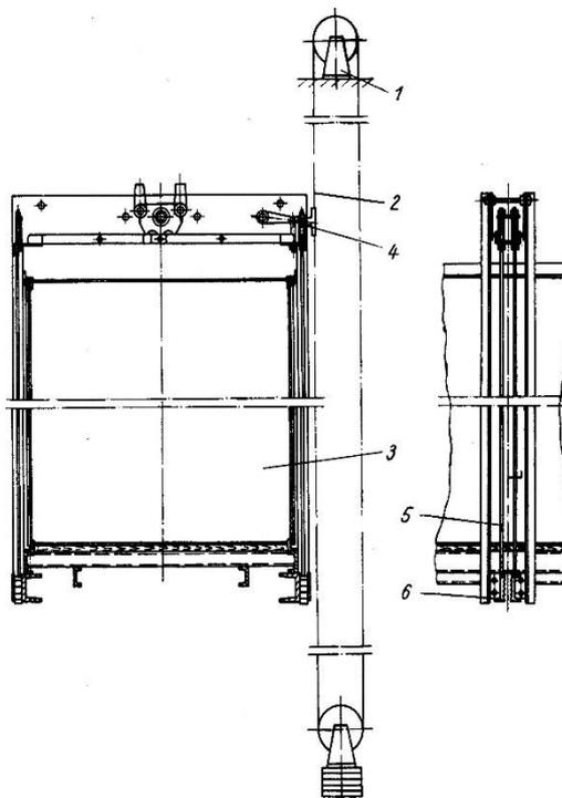
Slika 20 Uključni mehanizam zaustavnog uređaja na kabini [1]
