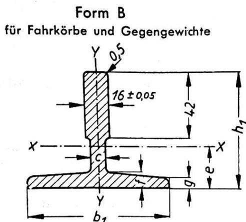
Slika 31 Dimenzije specijalnog profila T90 [7]
