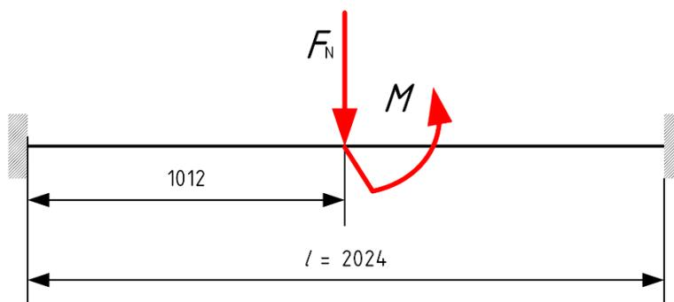
Slika 50 Proračunski model poprečne ukrute voznog okna
