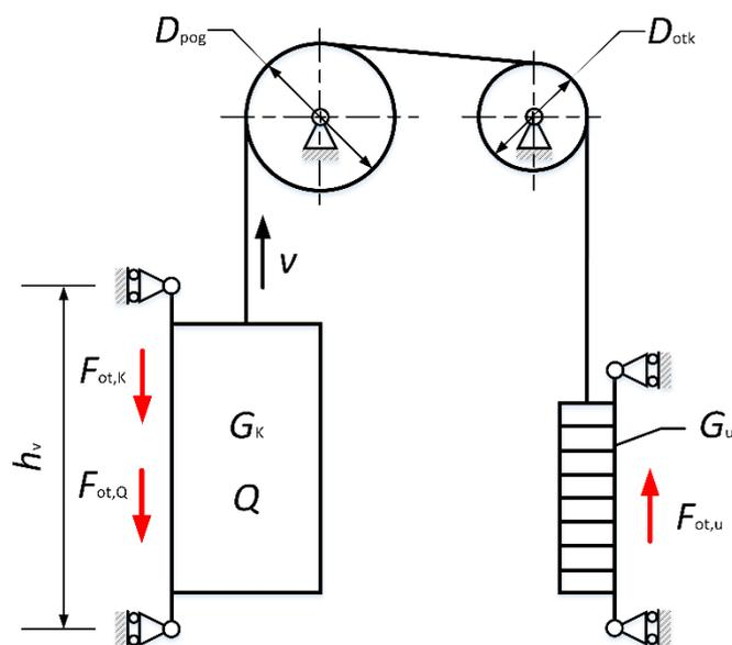
Slika 5 Shematski prikaz konstrukcijske izvedbe dizala s protuutegom i odstojnom užnicom
