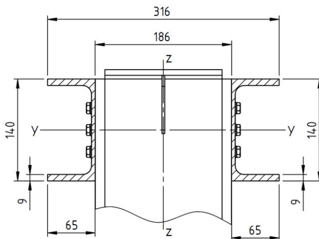
**Slika 38** Poprečni presjek gornje grede nosivog okvira kabine
