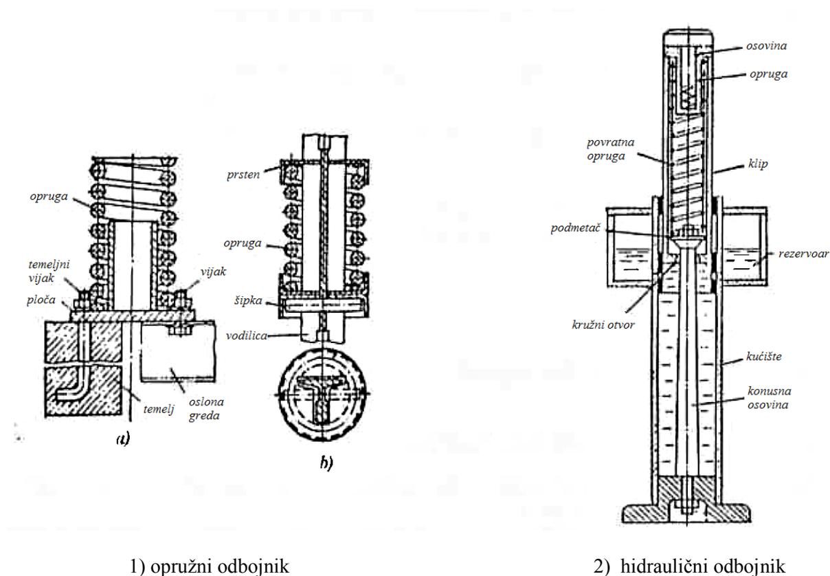
Slika 24 Konstrukcijska izvedba opružnog i hidrauličkog odbojnika [2]
