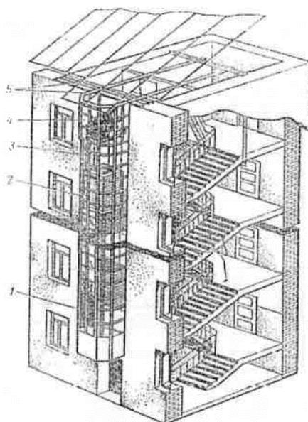
**Slika 17** Prikaz visećeg fasadnog voznog okna [2]
